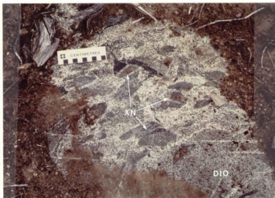
Figure 37 - Pluton du canton de Cavelier; xénolites d'amphibolite (XN) dans une diorite (DIO) (photo 15-10).
