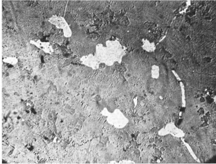
PLANCHE II A — 53.2 p. 100 de matte de cuivre —x100 Bornite avec taches de cuivre métallique.
