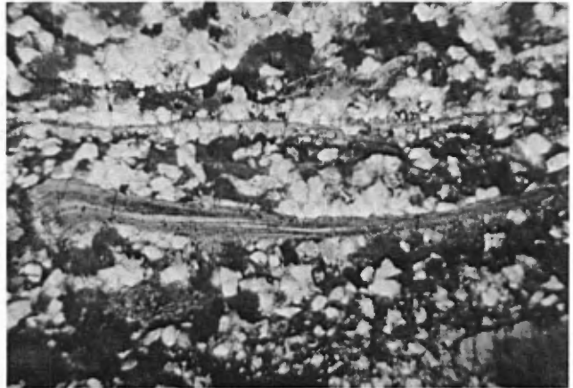
B - Subarkose laminée de la formation de Saint-Roch, X30; fragments de tribolite et de siltstone avec une abondance de grains de glauconie (gris foncé), de quartz et de feldspath.
