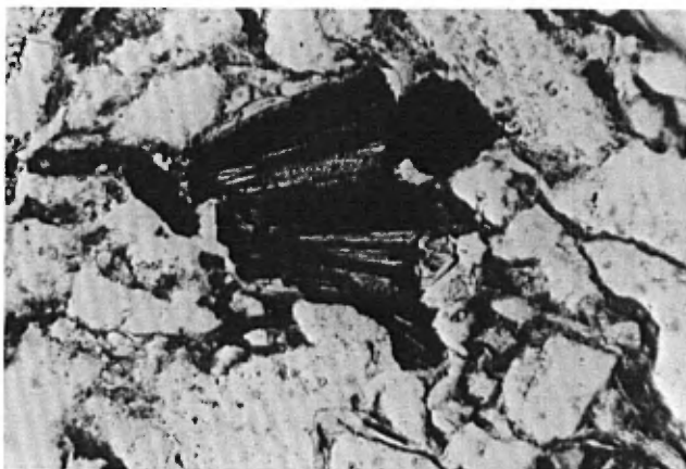
C - Arkose d'Armagh, X70; grain de biotite altéré en hématite et en un minéral incolore. Notez les particules d'hématite dans la matrice. Armagh arkose, X70; grain of biotite altered into hematite and colorless mineral. Note specks of hematite in matrix.
