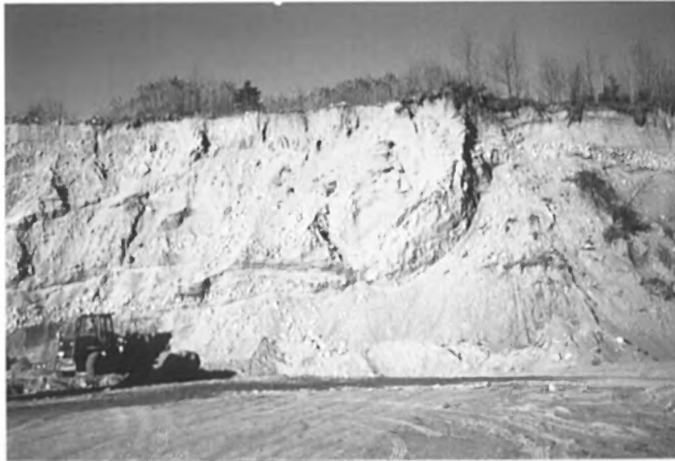
Photo 7 : Dépôt fluvio-glaciaire, près de Stoneham, composé de 8 à 12 m de sable entremêlé de gravier (banc 60, gisement 12)
