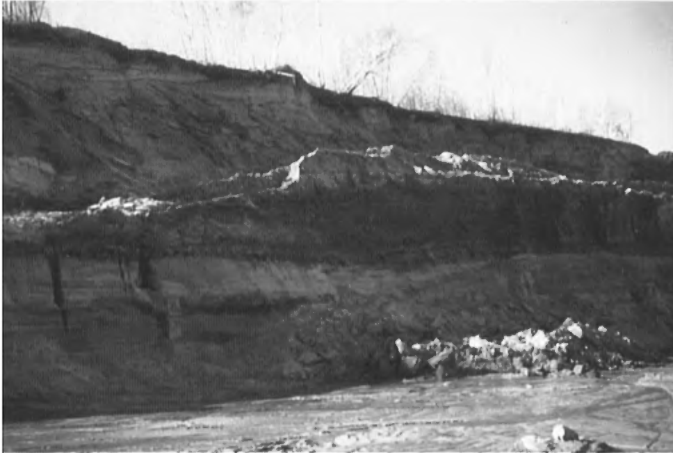
Photo 17 : Face de 10 m de hauteur dans un dépôt fluvio-glaciaire composée de sable inter-stratifié de gravier et de silt (banc 51, gisement 23)
