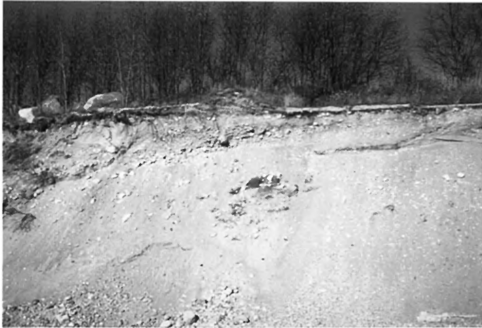
Photo 11 : Face de 8 à 10 m de hauteur exposant des matériaux grossiers à l'intérieur de la moraine du lac Saint-Charles (banc 70, gisement 16)
