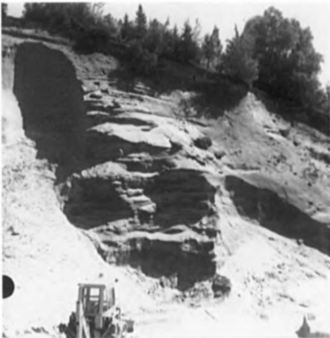
Photo 2 : Terrasse fluvio-glaciaire de plus de 10 m de hauteur exploitée dans la partie nord de la vallée de la rivière Montmorency (vue éloignée et vue rapprochée, banc 13, gisement 6)
