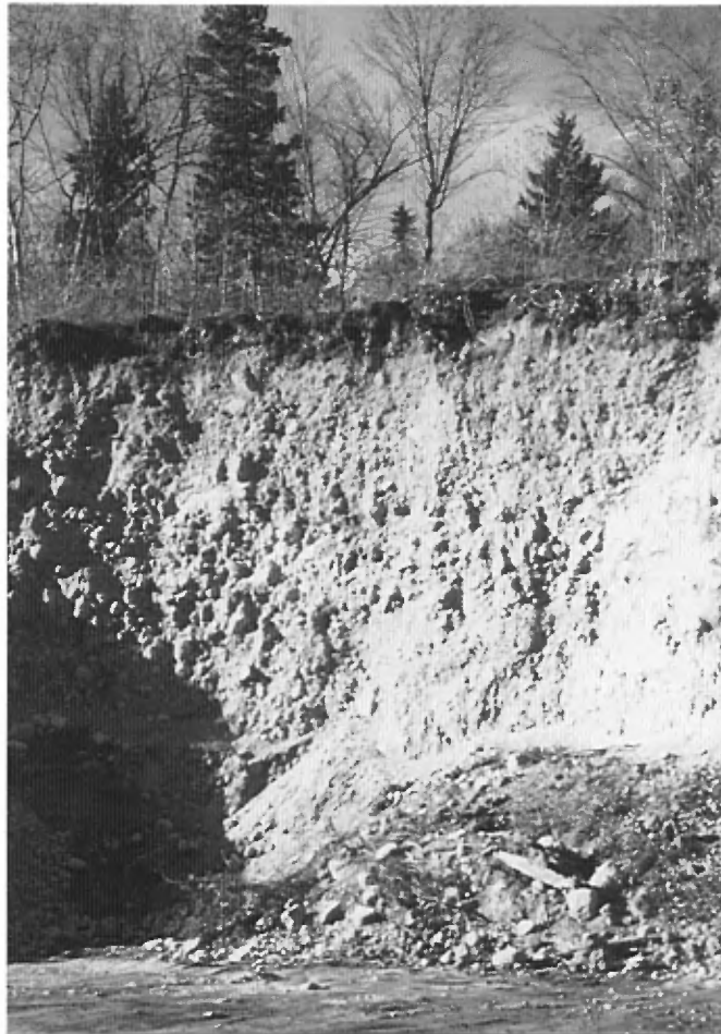
Photo 13 : Face de 6 à 8 m de hauteur composée de gravier et de cailloux arrondis à l'intérieur de la moraine du lac Saint-Charles (banc 68, gisement 16)
