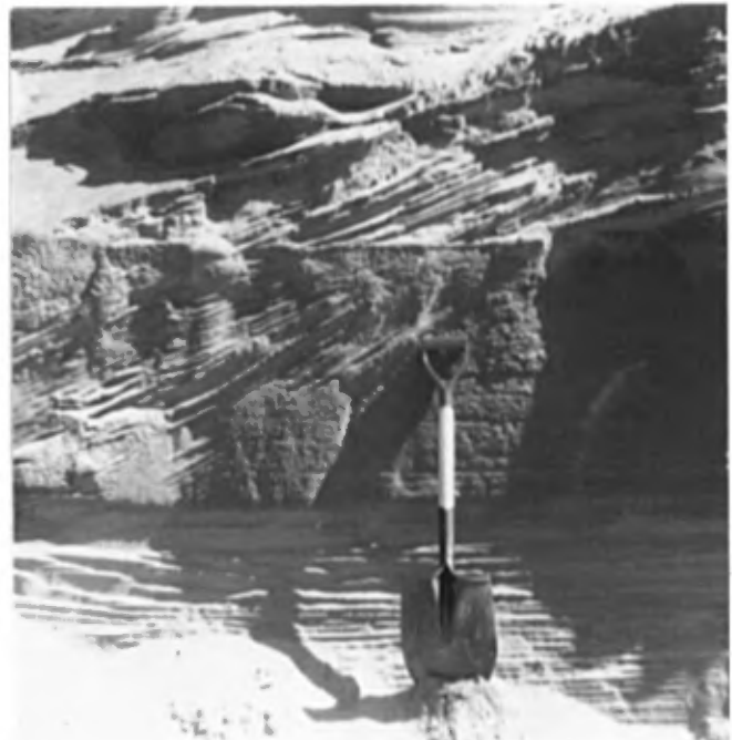
Photo 2 : Terrasse fluvio-glaciaire de plus de 10 m de hauteur exploitée dans la partie nord de la vallée de la rivière Montmorency (vue éloignée et vue rapprochée, banc 13, gisement 6)
