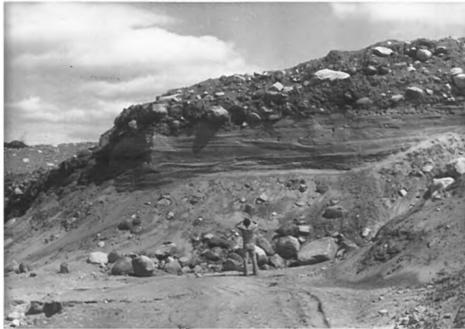
Photo 21 : Sable stratifié recouvert de matériaux grossiers hétérogènes dans un dépôt fluvio-glaciaire à Saint-Augustin (côté sud du banc 115, gisement 23)
