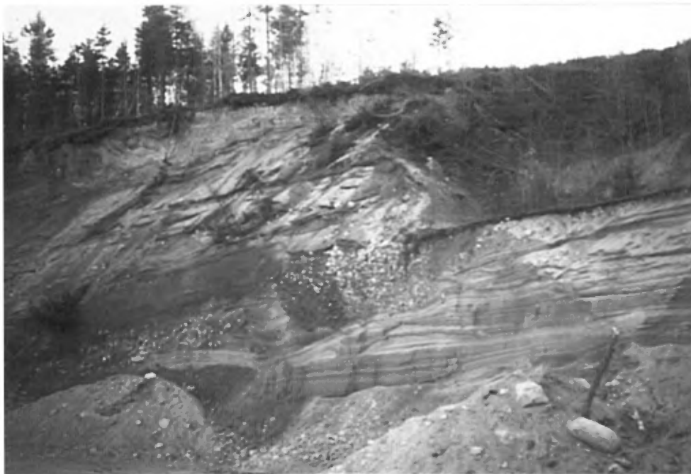
Photo 8 : Matériaux hétérogènes d'origine fluvio-glaciaire (banc 60, gisement 12)
