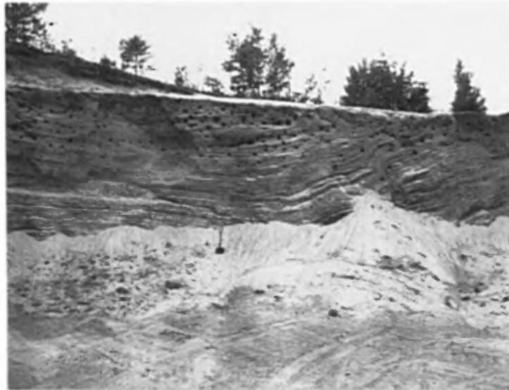
Photo 1 : Face de 5 m de hauteur composée de sable moyen stratifié d'origine marine (banc 7, gisement 4)
