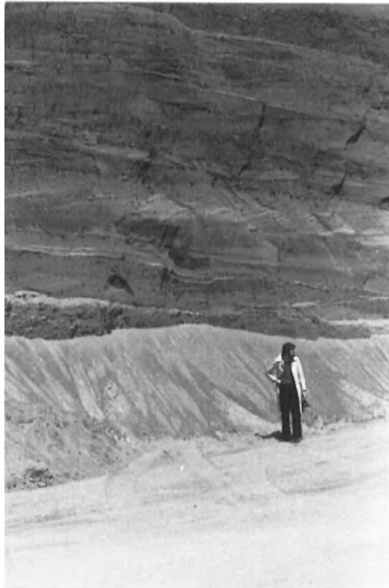
Photo 19 : Face de sable faiblement graveleux d'origine fluvio-glaciaire à Saint-Augustin (côté nord du banc 115, gisement 23)
