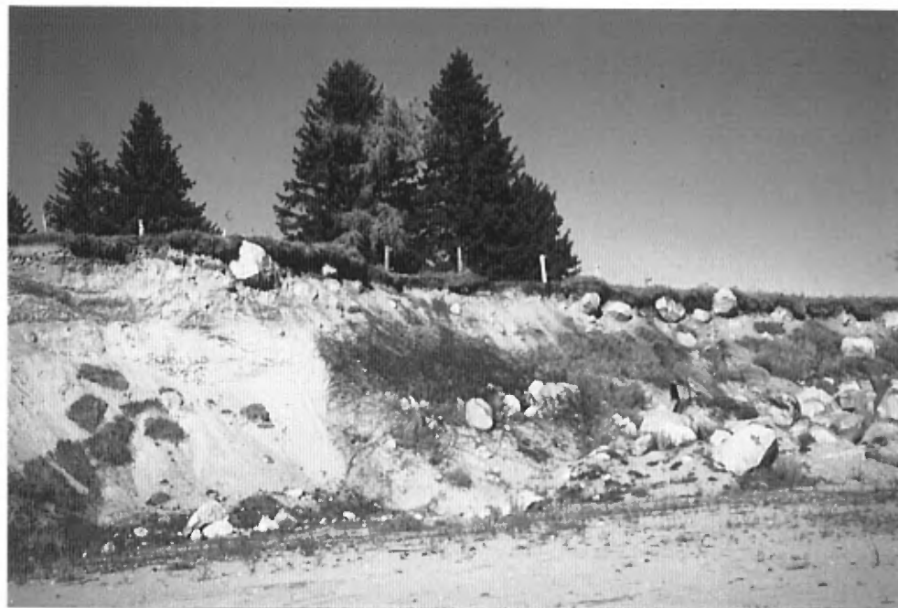
Photo 14 : Matériaux hétérogènes qui consistent surtout en sable avec des poches de gravier et des blocs à l'intérieur de la moraine du lac Saint-Charles (banc 76, gisement 16)
