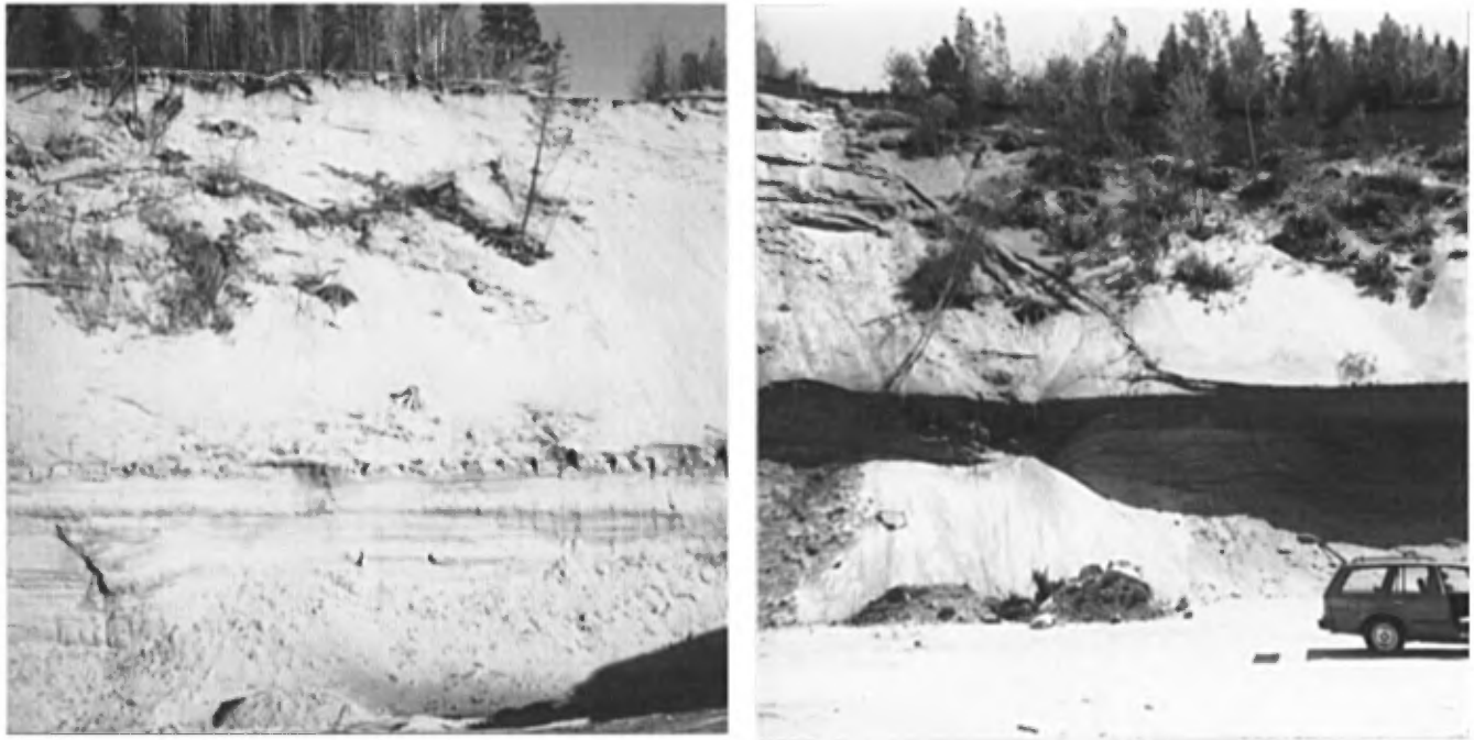
Photo 3 : Faces de 15 m de hauteur à l'intérieur du delta de la rivière Montmorency constituées principalement de sable moyen (banc 27, gisement 6)
