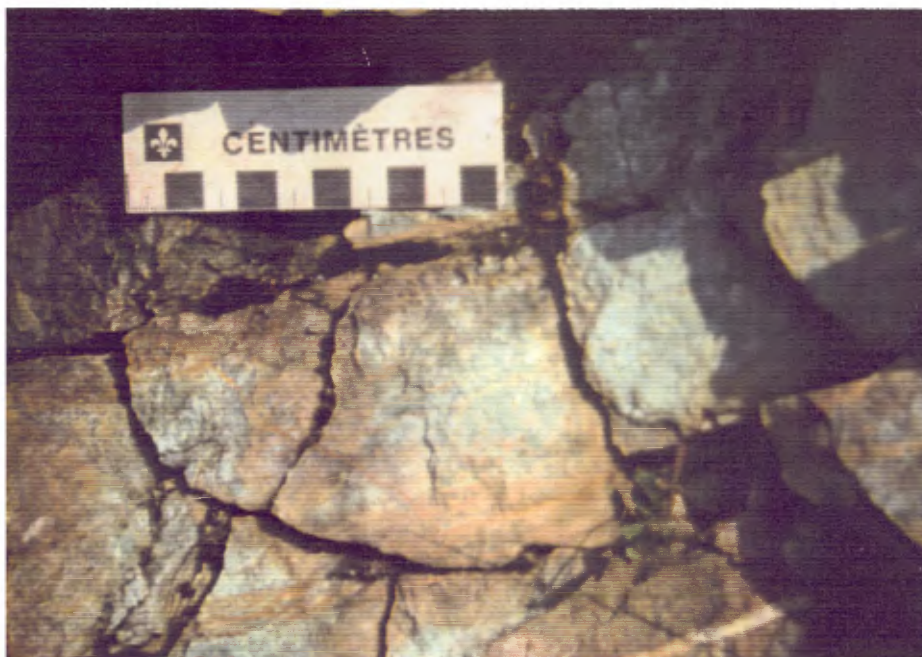
Figure 4 : Placage de fuchsite sur les plans de la schistosité dominante S1-2 du Schiste à quartz et mica blanc de la Suite de Sutton, en contact avec la dolomie à talc \pm fuchsite (Coupe routière à l'ouest d'Eastman, du côté sud de l'autoroute 10, près de la borne kilométrique 101).
