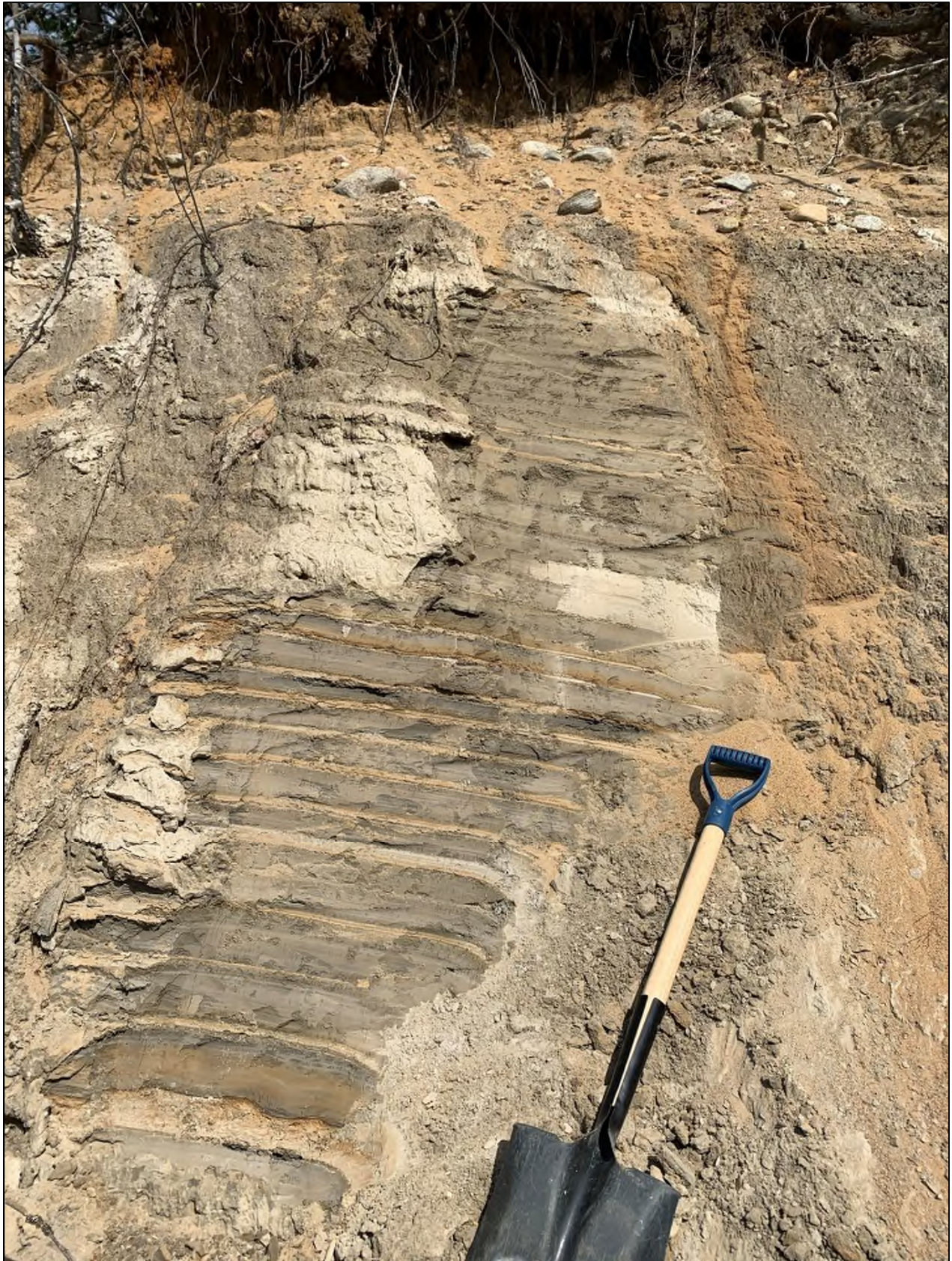
Figure 31 | Exemple de dépôts glaciomarins fin d'eau profonde avec litage à la station #194 (EB0602194). La présence d'horizons silto-sableux augmente la perméabilité et l'anisotropie.
