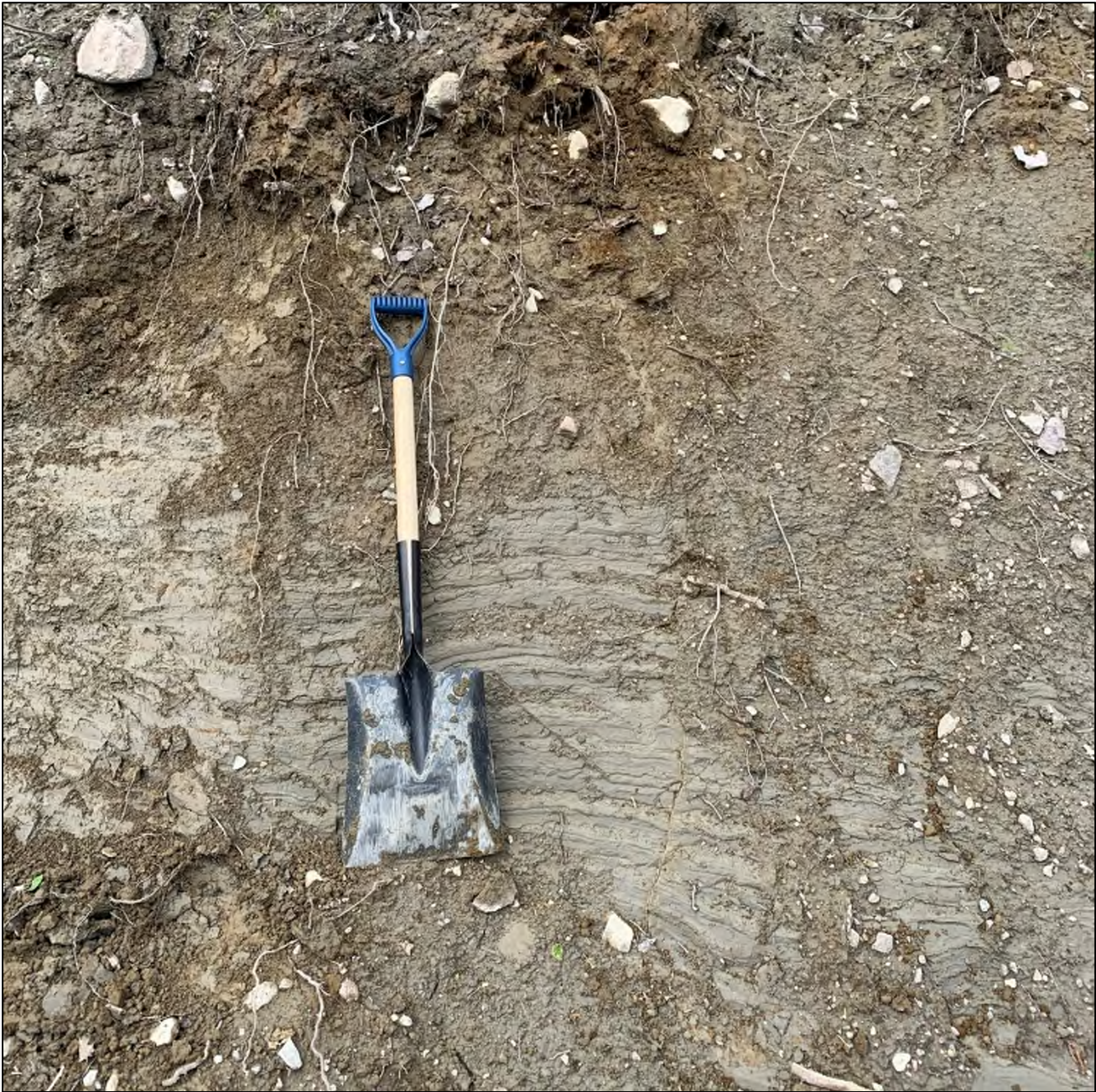
Figure 30 | Exemple de dépôts glaciomarins fin d'eau profonde avec litage à la station #123 (EB0527123).
