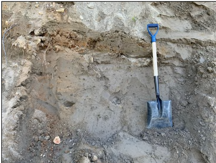
Figure 13 | Exemple de till de fond en couverture continu lâche la station #97 (EB0524097). La partie supérieure de ce till est très lâche comme en témoignent les cavités laissées par le matériel qui a glissé vers le bas de la coupe.
