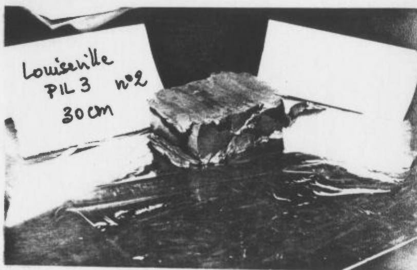
b - Echantillon 5 × 5 cm horizontal W_N = 32,6
