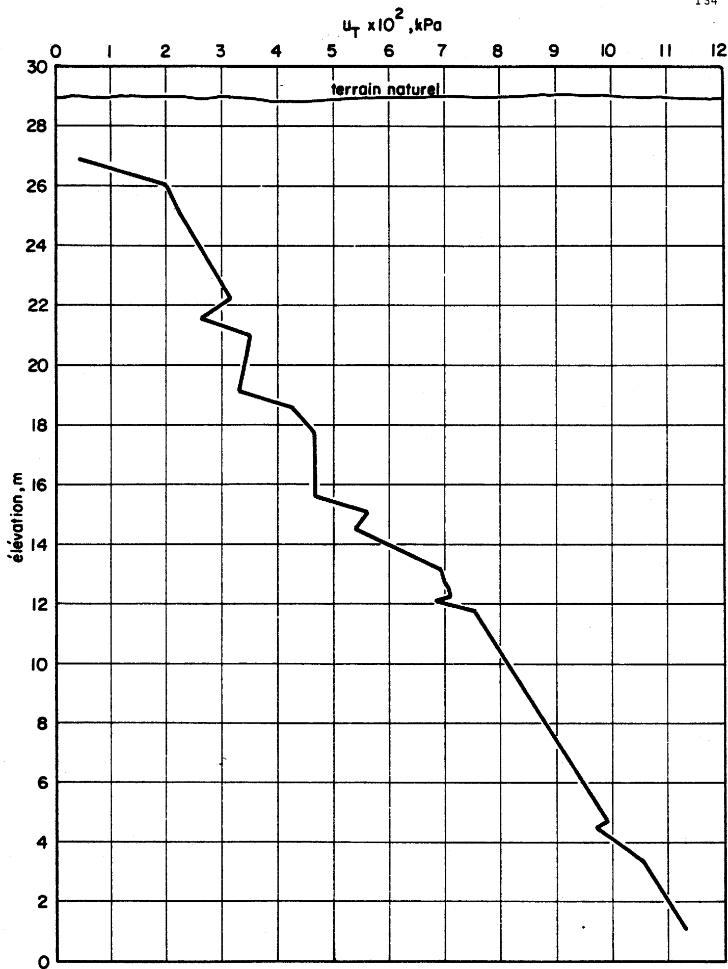
Fig. 9 — PROFIL DE u_T , ST-LÉON, PIÉZOCÔNE N° 1.
