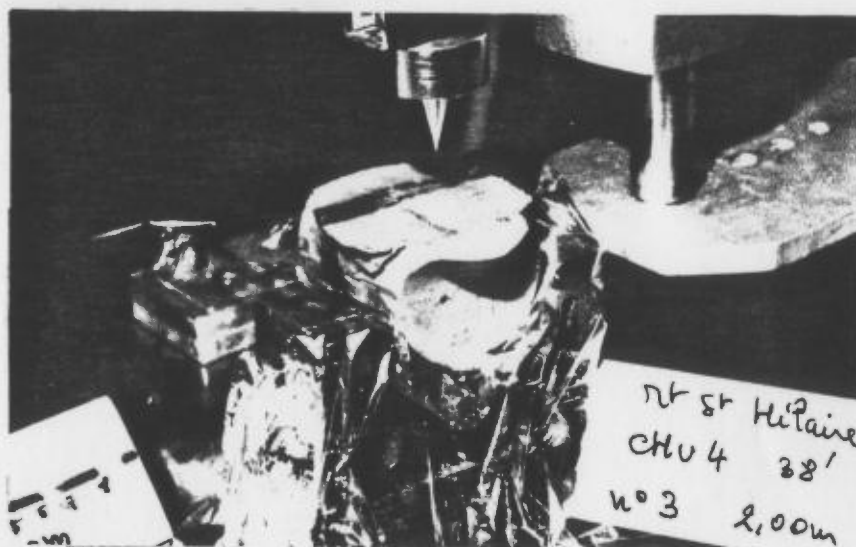
b - Mesure de la résistance au cisaillement
