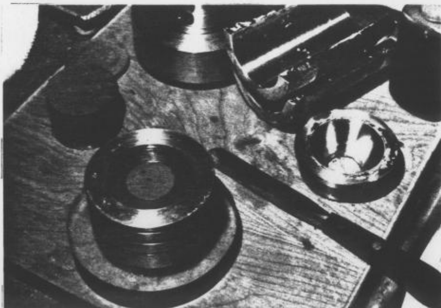
a - Découpage de l'échantillon restant en rondelles, Saint-Léon, 75% de réduction de section
