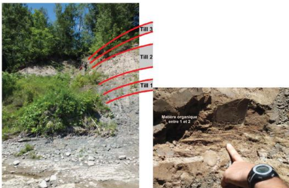
Figure 9 : Une section à trois tills, localisée 10 km à l'aval de Ste-Brigitte des Saults le long de la Nicolet Sud-Ouest; à gauche : la succession roc/till/sables organiques/till/sables organiques/till; à droite : matière organique dans l'unité nonglaciaire correspondant au Sables de Lotbinière.
