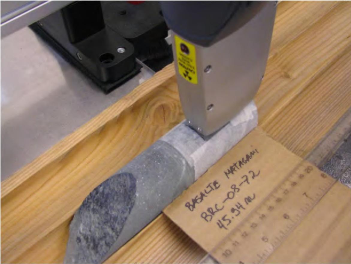
**Figure 23.** Test de précision de l'analyseur XRF portatif Alpha sur une carotte de forage de Matagami.
