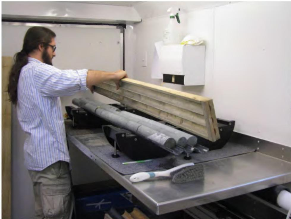
**Figure 2.** Système de transfert des carottes de forage dans les bateaux en fibre de verre. Il s'agit ici de carottes NQ. Les carottes sont brossées avant le transfert (côté « endroit ») et après le transfert (côté « envers ») pour éliminer un maximum de poussière et autres débris de leur surface.
