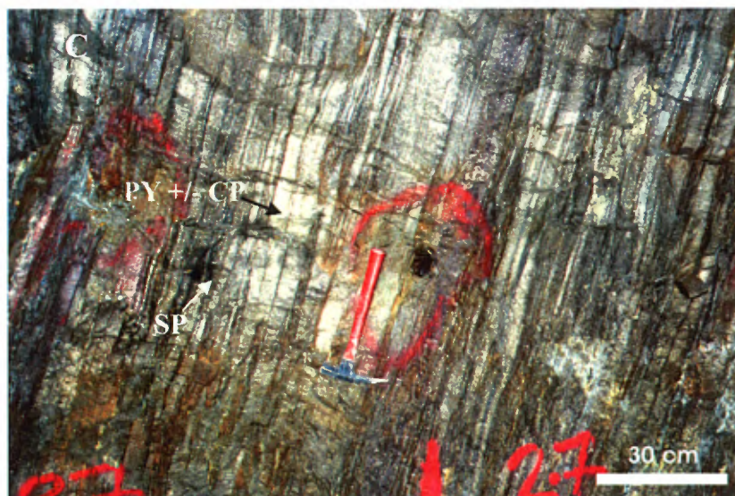
PLANCHE 2C. Vue en coupe de la lentille 20S avec bandes de pyrite (PY) semi-massive, avec chalcopyrite (CP) et sphalérite (SP) illustrant la texture rubanée produite par la transposition du stockwerk de sulfures. Niveau 146.
