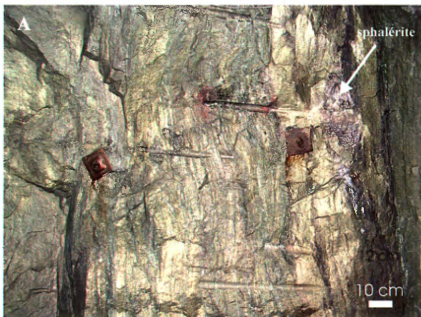
PLANCHE 3A. Vue en coupe verticale montrant une zone de sulfures massifs aurifère (pyrite+chalcopryrite+sphalérite) dans la lentille 20 Sud (chantier 106-21-80).
