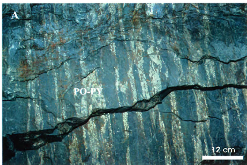
PLANCHE 2A. Vue en coupe de la zone de veinules ( stringers ) de pyrite-pyrrhotite dans l'andésite basaltique altérée. Les veinules sont transposées parallèlement à la foliation principale (Sp). Chantier 146-20-67.
