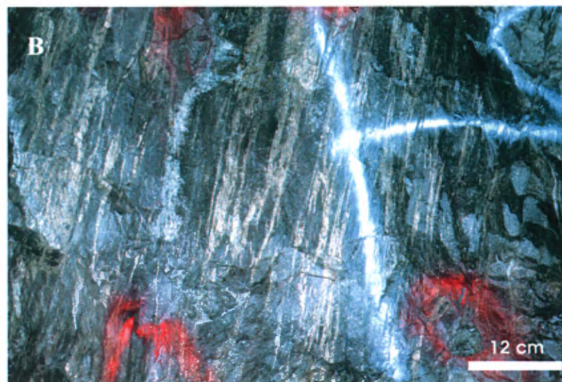
PLANCHE 2B. Vue en coupe montrant la lentille 20S avec veinules ( stringers ) de pyrite transposées parallèlement à la foliation principale (Sp). Niveau 146, section 7350E.
