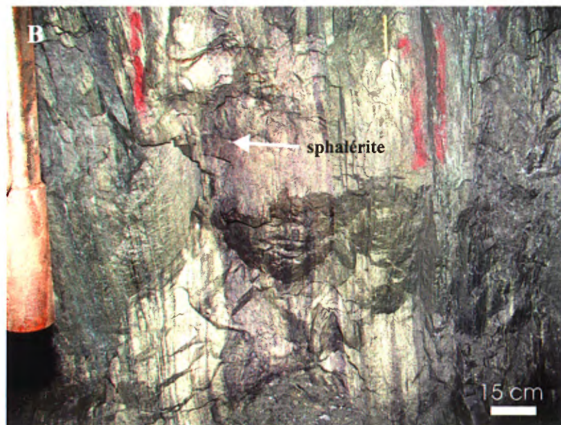
PLANCHE 3B. Vue en coupe verticale de la lentille 20S montrant des bandes de sphalérite dans une lentille de pyrite massive (chantier 106-21-80).
