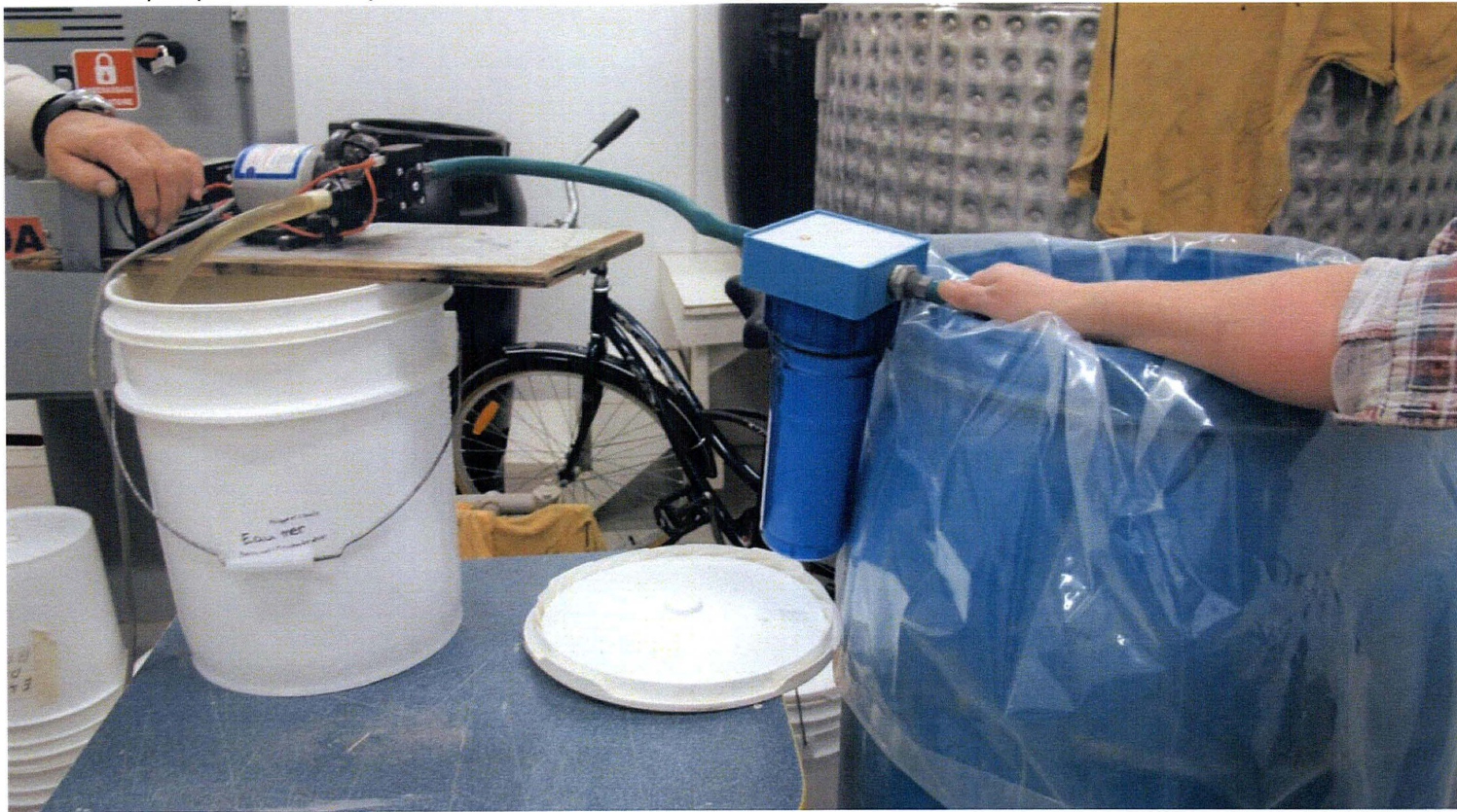
Essai avec pompe 12 volts et système de filtration à l'usine
