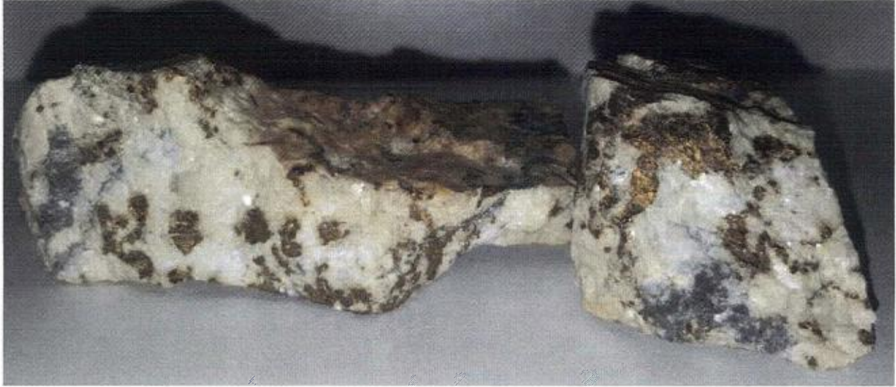
Figure 14 : Échantillon de minerai brisé montrant à l'intérieur la chalcopirite qui est peu ou pas altérée
