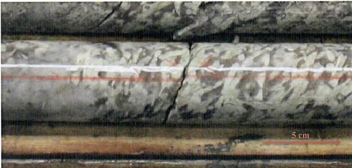
Figure 5. 3: Pegmatite à spodumène, sondage AL-16-017
