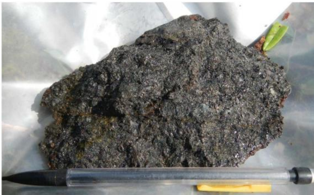
Figure 6: Minéralisation semi-massive (26,9 % Cg). Échantillon 531416, affleurement 14-GM-266.
