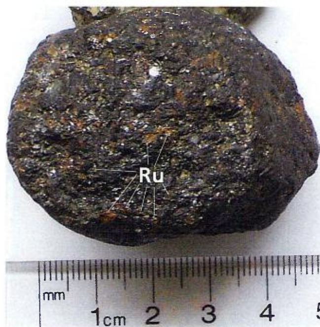
Figure 13 : Bloc d'ilménite à rutile FH-5. Secteur de la montagne C. Spécimen comportant environ 25-30 % de rutile (Ru). Surface naturelle, polie due au transport.
