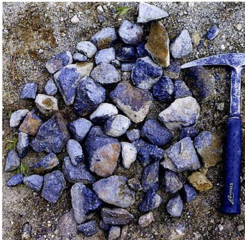
Figure 28 : Site 70790232. Nombreux blocs d'ilménite sans rutile dans un rayon de 20 mètres, tous angulaires, suggérant une source locale.
