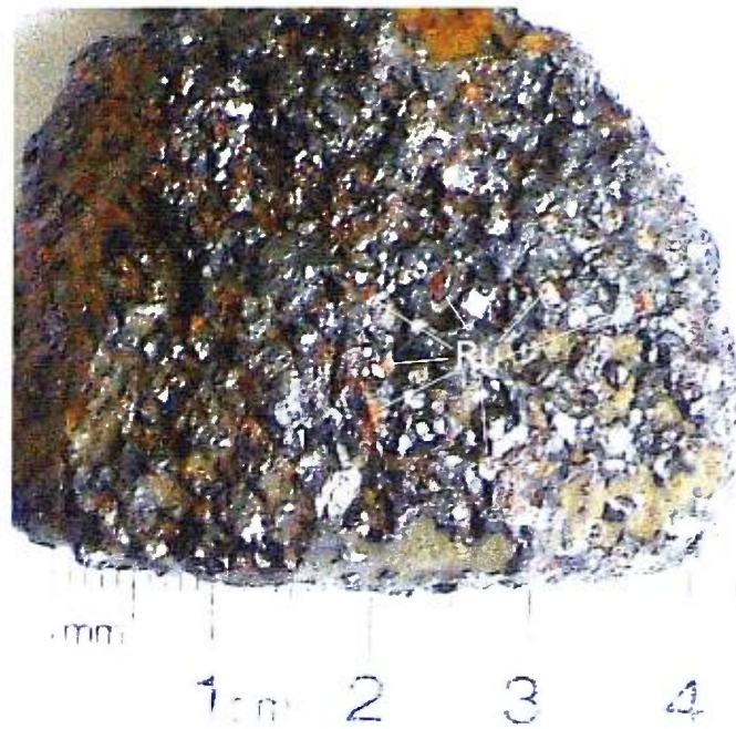
Figure 14 : Bloc d'ilménite à rutile FH-8. Secteur de la montagne C. Spécimen comportant environ 40 % de rutile (Ru). Surface naturelle, dominée par la texture granulaire.
