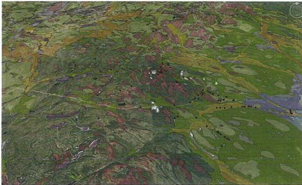
Figure 33 : Carte des dépôts quaternaires drapée sur la vue aérienne, sur laquelle les reliques de tills minces et discontinus sur le sommet du massif sont visibles en bourgogne et en vert pâle, la plaine de till épais correspondant à la terrasse est visible en vert, les sédiments d'épandage en jaune, les sédiments glaciomarins en lilas, les dépôts alluvionnaires en beige et les sédiments juxtaglaciale ou de la moraine frontale en orange.
