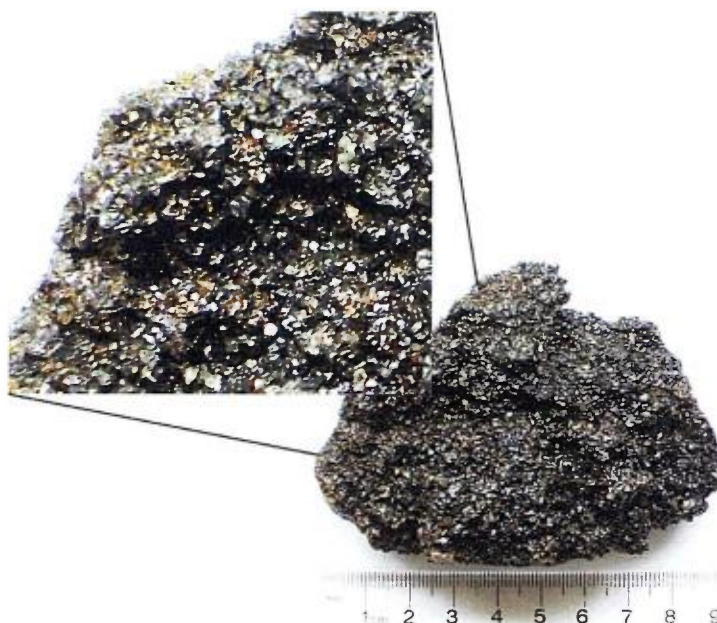
Figure 12 : Bloc d'ilménite à rutile 70790160. Secteur de la montagne C. Spécimen granulaire comportant environ 30-35 % de rutile, visible sous forme de petits grains rouges à orangés. Surface naturelle, dominée par la nature granoblastique des minéraux.
