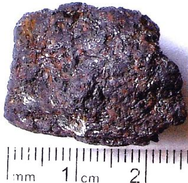
Figure 21 : Fragment d'ilménite à rutile de l'échantillon témoin 70790225. Sommet adjacent au sud du Mont Blanc du Grand Lac, environ 35-40 % rutile. Photo dont le contraste a été rehaussé. Face usée du fragment.
