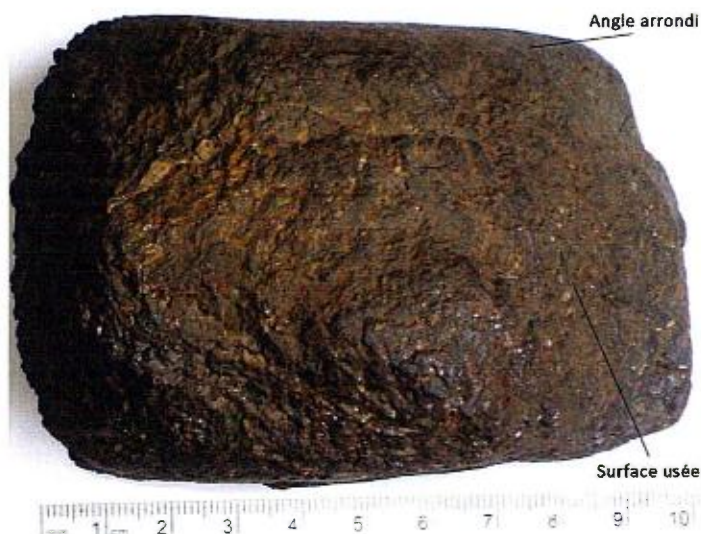
Figure 16 : Bloc témoin d'ilménite à rutile 70790222. Sommet de la montagne B, environ 25-30 % rutile.
