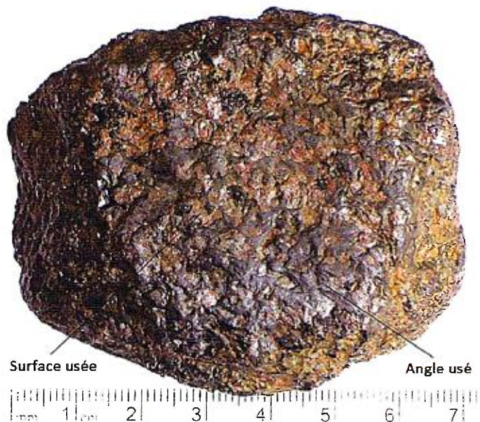
Figure 15 : Bloc témoin d'ilménite à rutile 70790216. Crête sud-est de la montagne B, sous un arbre déraciné. Environ 45 % rutile, face usée. Image dont le contraste a été rehaussée. On remarque la surface émoussée par le transport.
