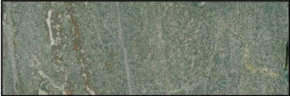
Figure 13 : Sous-unités 4A : la magnétite est abondante sous forme disséminée. L'hématite rouge est visible. Et la présence de silicates de fer est suspectée. La pyrite est localement observée.
