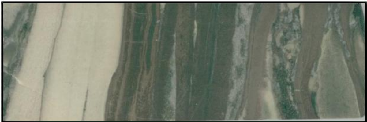
Figure 9 : Sous-unité 2C rubanée de couleur grise à blanche, avec la présence de lits pluri-centimétriques blancs de chert et de magnétite. Le chert blanc est totalement dépourvu de grains de magnétite ou de poussières d'hématite.
