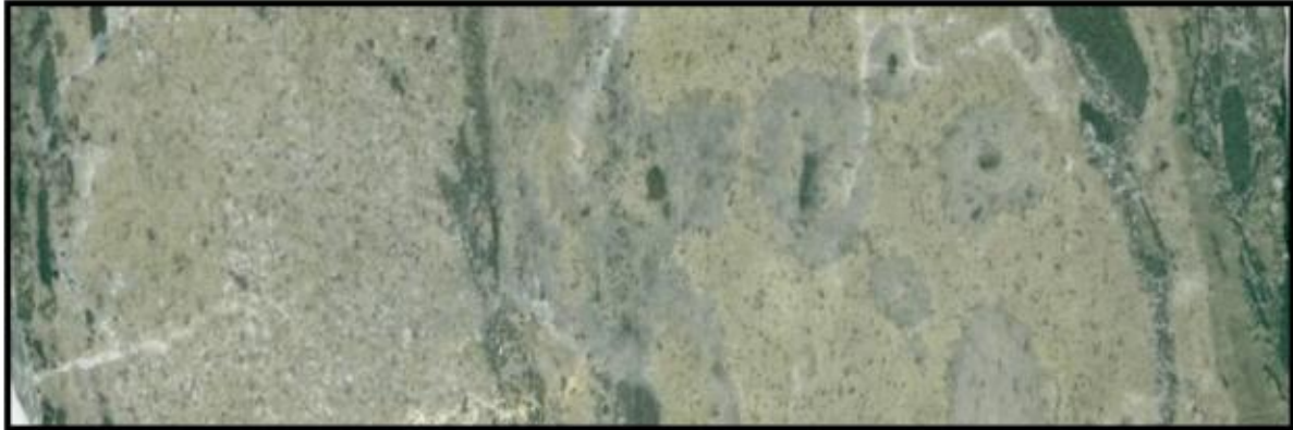
Figure 12 : Sous-unité 3C : la matrice jaunâtre est principalement composée de silice amorphe et de carbonate. Cette sous-unité présente des fractures, généralement remplies par des carbonates. Une forte réaction à l'acide indique la présence de calcite.
