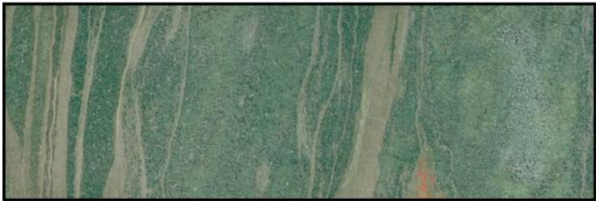
Figure 11 : Roche grise de la sous-unité 3B. Alternance de bandes millimétriques à centimétriques de magnétite avec des bandes pluri-centimétriques de chert blanc présentant une texture sableuse. Présence de pyrite et de carbonate suspectée dans la matrice siliceuse. Les lits de magnétite sont affectés par des plis syn-sédimentaires.
