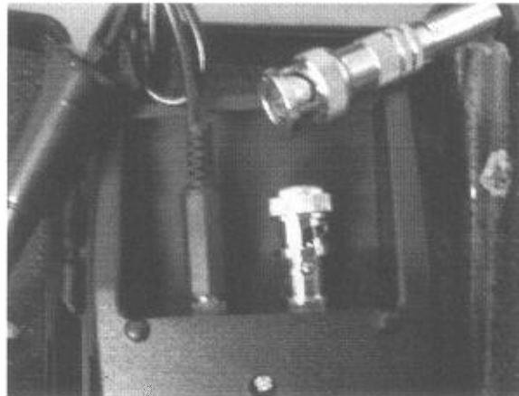
Figure 5 : Arrière du pH-mètre : connexion de l'électrode à droite de l'image, connexion de la sonde de température à gauche de l'image
