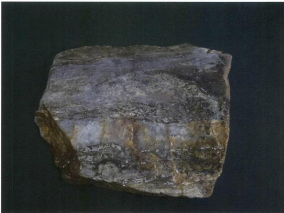
Figure 6. Métasédiments à veine de QZ minéralisée (NC2010-TR-001, éch 157647,). Minéralisation d'arsénopyrite en amas grossiers dans les épontes de veines de quartz injectées dans un métasédiment. Cet échantillon a donné 3,35 g/t Au sur 1,0m
