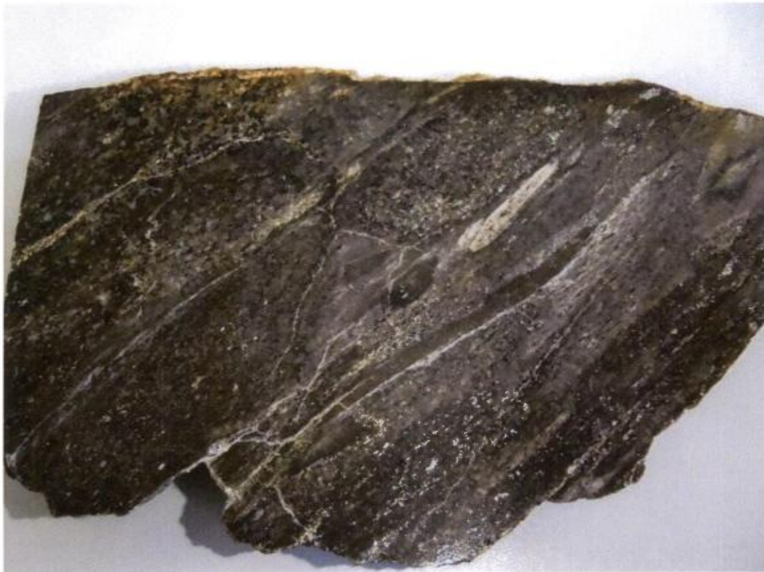
Figure 5. Conglomérat minéralisé de l'indice Portageur (éch. 157944). Arsénopyrite disséminée dans la foliation et en filonnets. Les sulfures sont observés dans la matrice et les fragments. Cet échantillon a donné 2,69 g/t Au sur 1,0m.
