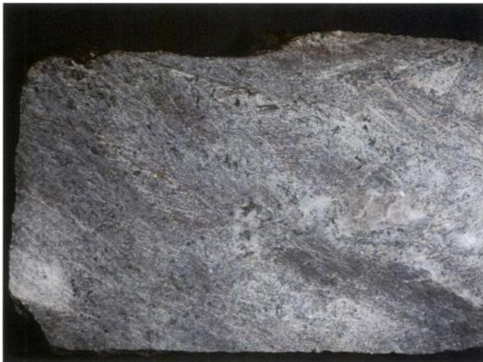
Figure 7. Zone fortement métasomatisée (NC2010-TR-010) au contact avec les conglomérats minéralisés de la zone Portageur (éch 202819, NC2010-TR-010). Les zones gris violacés représentent des zones biotisées à grains très fins alors que les grains verdâtres aciculaires sont des amphiboles (actinote?). Ces unités ne présentent pas de valeurs aurifères. Le protolithe reste encore à définir.
