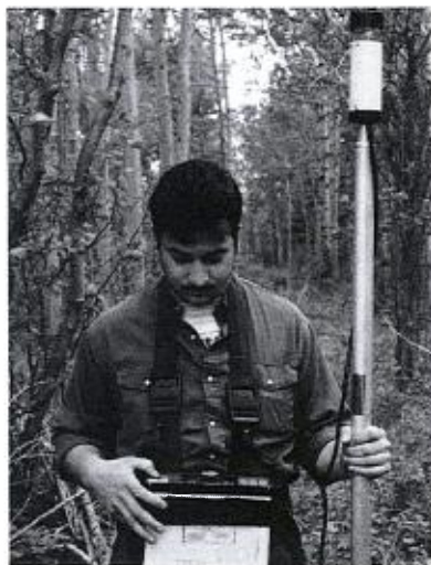
PHOTO 5.1 LEVÉ MAGNÉTIQUE AVEC UN MAGNÉTOMETRE À PROTONS.
