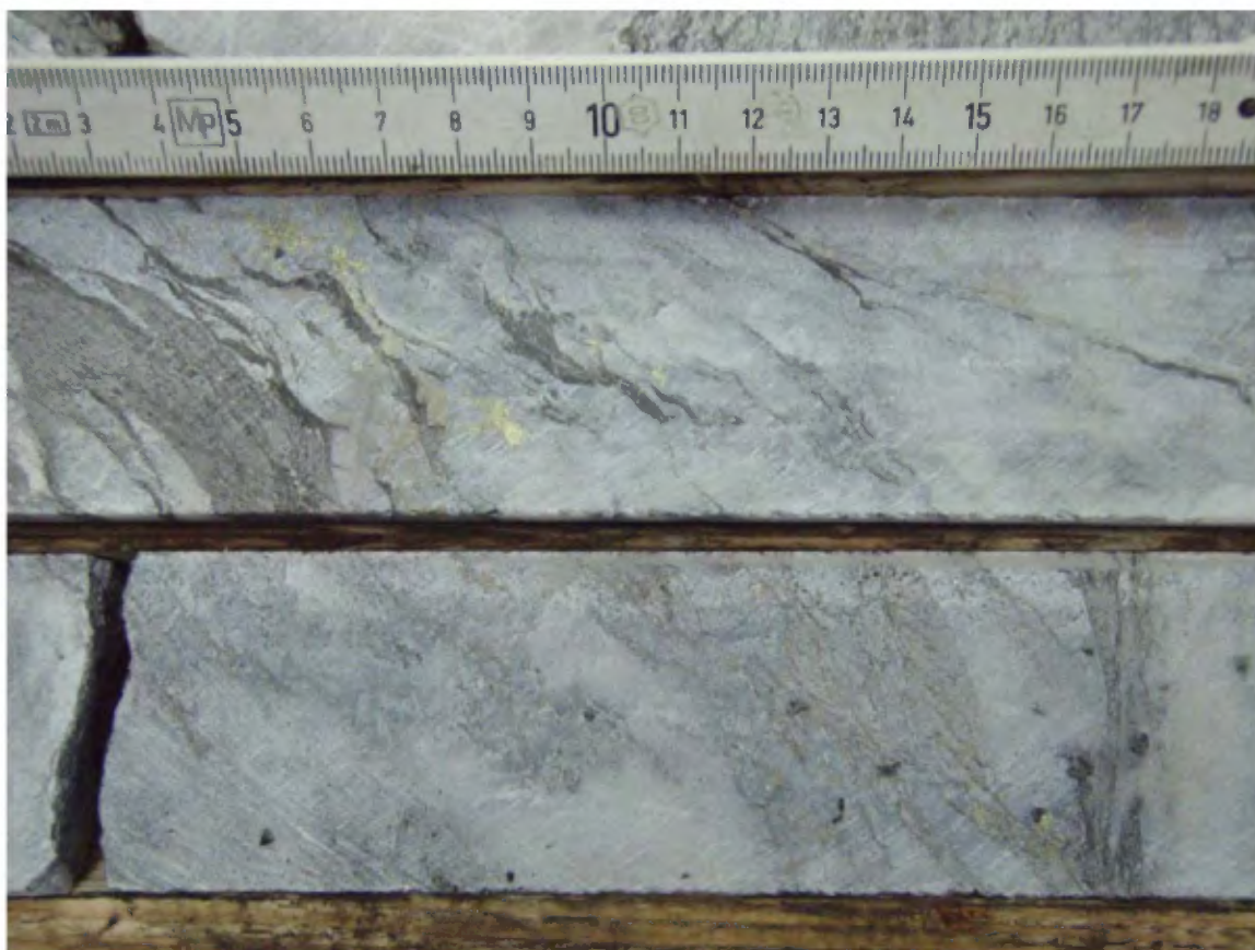
Figure 6.3.2 – Photo d’une veine minéralisée en chalcopyrite et en pyrite dans la zone riche en quartz située dans le sondage ML-08-11 (vers 273m)
