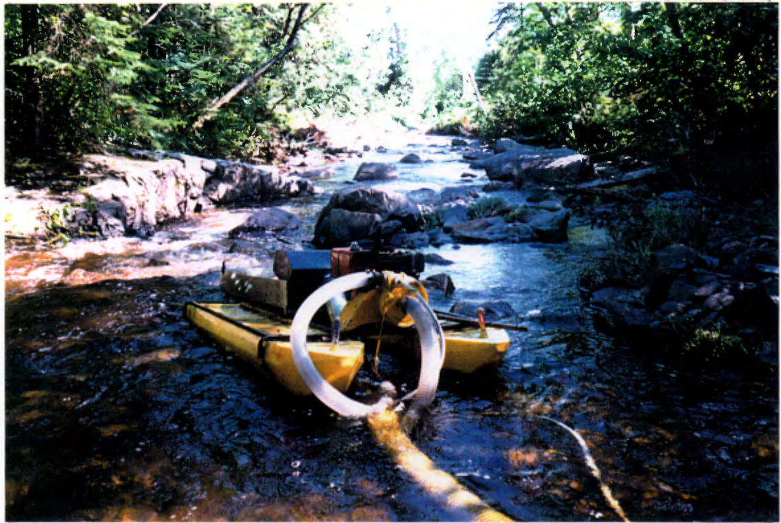
Drague à sluice en opération (sur le lot 20)
