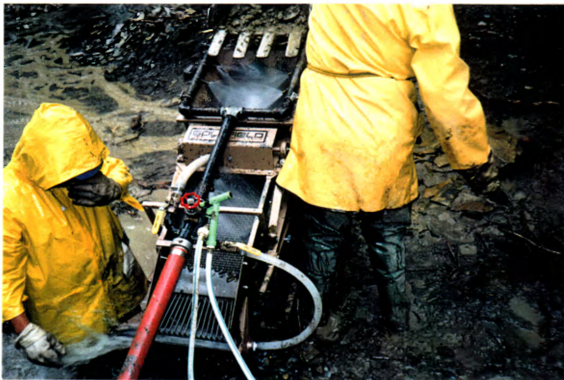
Détail des opérations de lavage du gravier. Sluice "Prospector" de Goldfield Engineering (Utah), capacité 2-4 vges 3 /h (réelle 1vge 3 /h), pompe "Monarch" et moteur de 5 HP.
