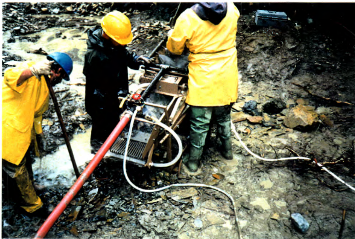
Détail des opérations de lavage du gravier. Sluice "Prospector" de Goldfield Engineering (Utah), capacité 2-4 vges 3 /h (réelle 1vge 3 /h), pompe "Monarch" et moteur de 5 HP.
