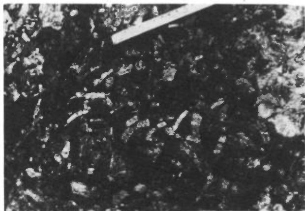
FIGURE 5 - Muscovite argentée associée à du spodumène verdâtre à noirâtre, à du quartz enfumé et à du feldspath grisâtre. Prospect Colombe, localisé au sud du pluton de La Motte (voir carte n° 2168, hors texte).
