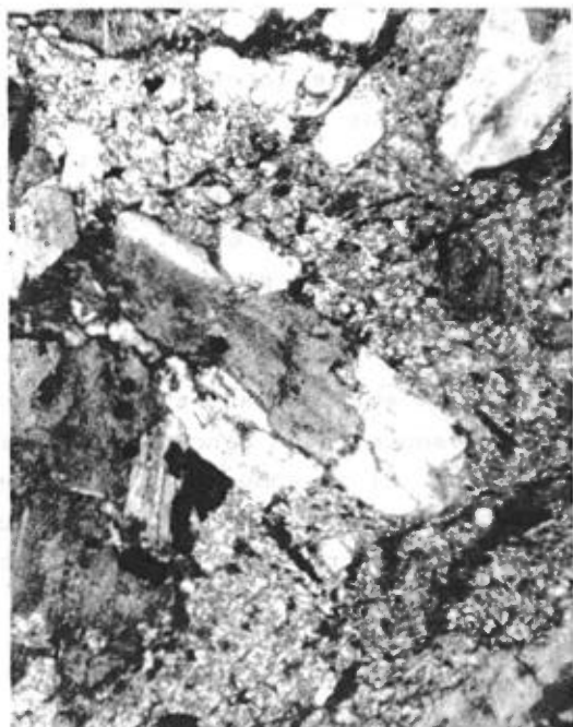
FIGURE 21 - Photomicrographie d'une lave aphanitique fracturée. Texture microlitique porphyrique; phénocristaux de feldspath maclés carlsbad dans une mé-sostase microlitique.
