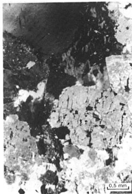
FIGURE 49 - Microphotographie de la tonalite de la colline Nissing. Noter le cristal de clinopyroxène de même que le caractère tardif du microcline.
