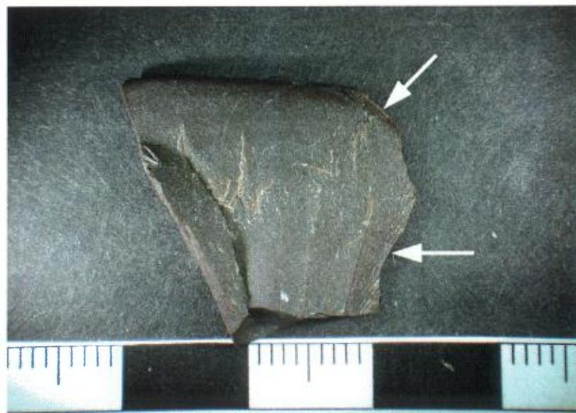
**PHOTO 54** – Granulat de cornéenne. Observez les bords tranchants (flèches) en périphérie du granulat. Échelle en cm.
