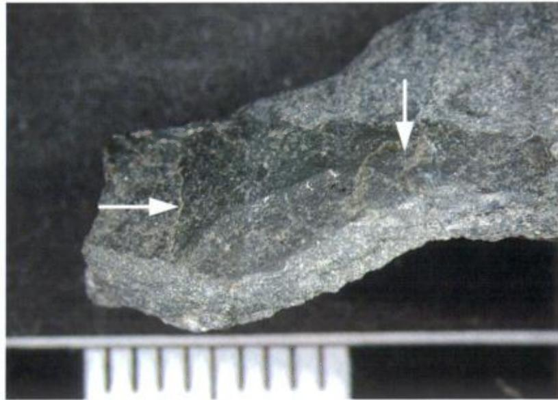
**PHOTO 34** – Granulat de calcaire avec placage argileux (flèches) vu à la loupe 10x. Échantillon non coloré. Échelle en cm.
