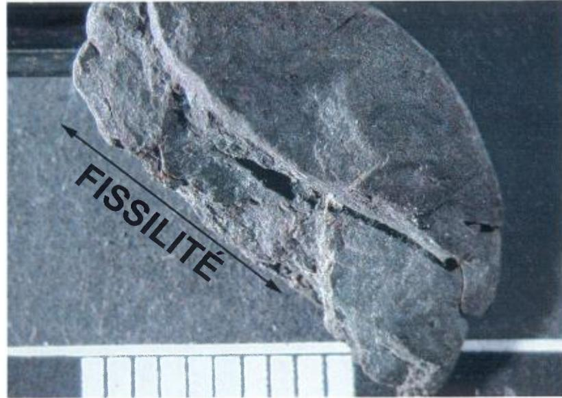
**PHOTO 10** – Granulat de shale vu à la loupe 10x. Observez les plans de fissilité. Échelle en cm.
