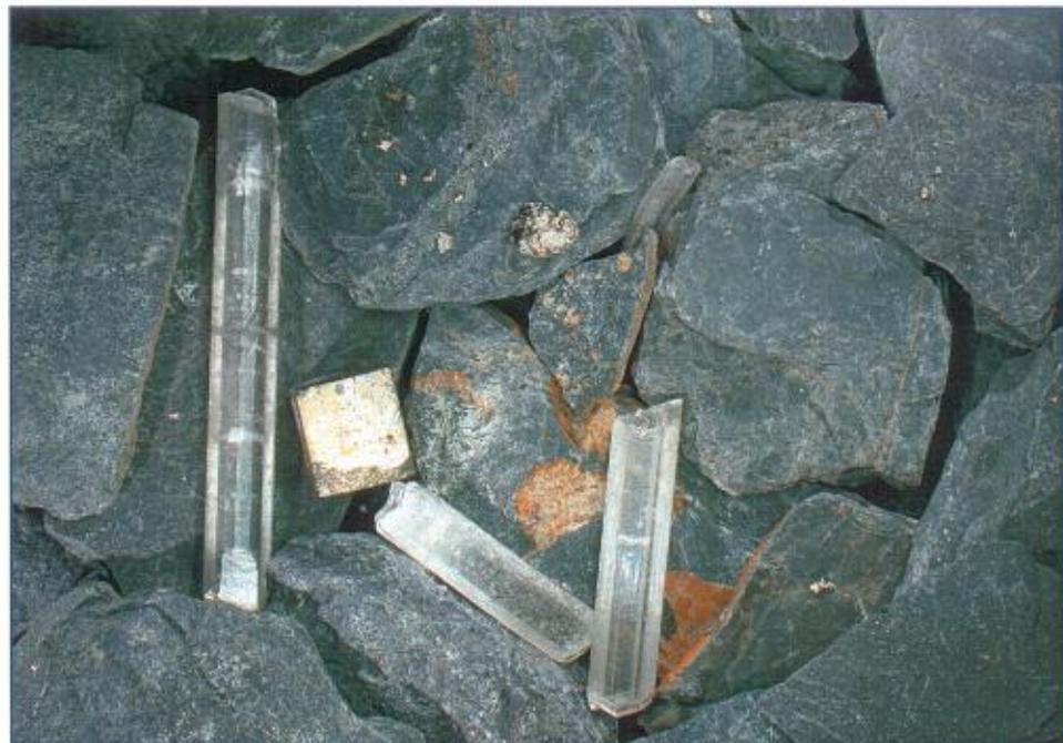
Granulats de calcaires et de shales avec cristaux de pyrite et de gypse.
