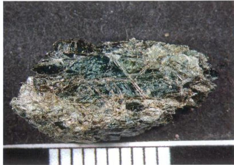
**PHOTO 50** – Granulat de schiste micacé vu à la loupe 10x. Observez les reflets très brillants des faces cristallines des micas. Échelle en cm.
