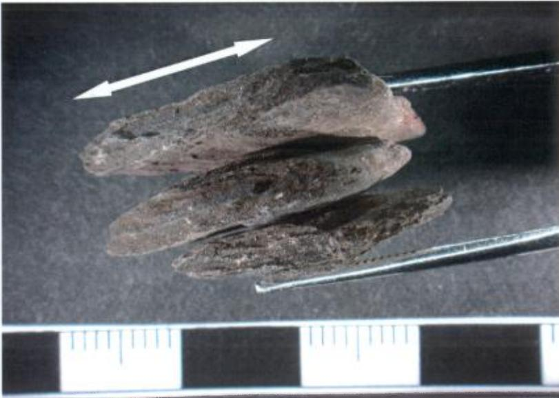
**PHOTO 25** – Granulats de calcaire argileux. Les fragments ont des formes de plaques. La double flèche indique l'orientation de la fissilité et des laminations. Coloration chimique. Échelle en cm.
