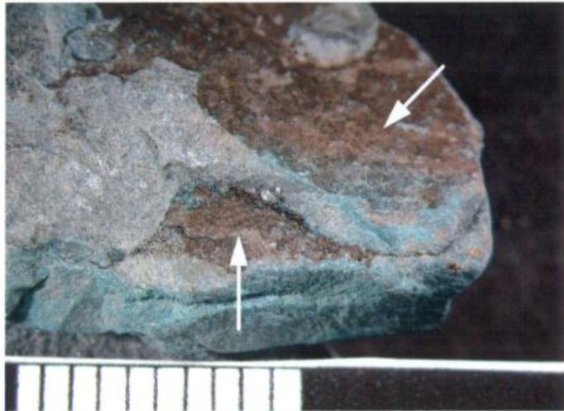
**PHOTO 36** – Exemple de dolomie avec placage argileux mince qui résulte du délitage selon des laminations de minéraux argileux (flèches). Coloration chimique. Vu à la loupe 10x. Échelle en cm.
