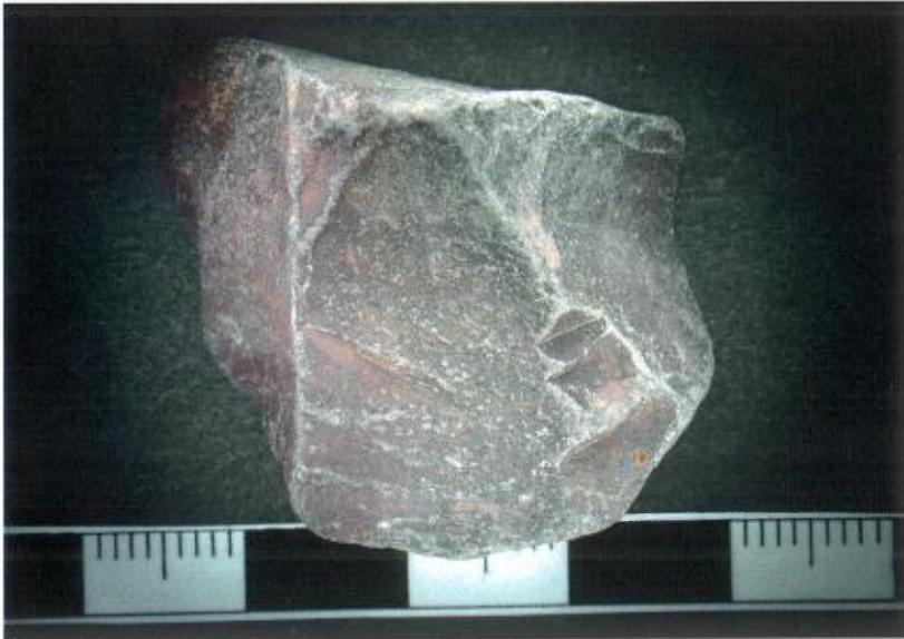
**PHOTO 41** – Granulat de calcaire à grain fin non argileux. Les surfaces exposées montrent des cassures pseudo conchoïdales. Coloration chimique. Échelle en cm.
