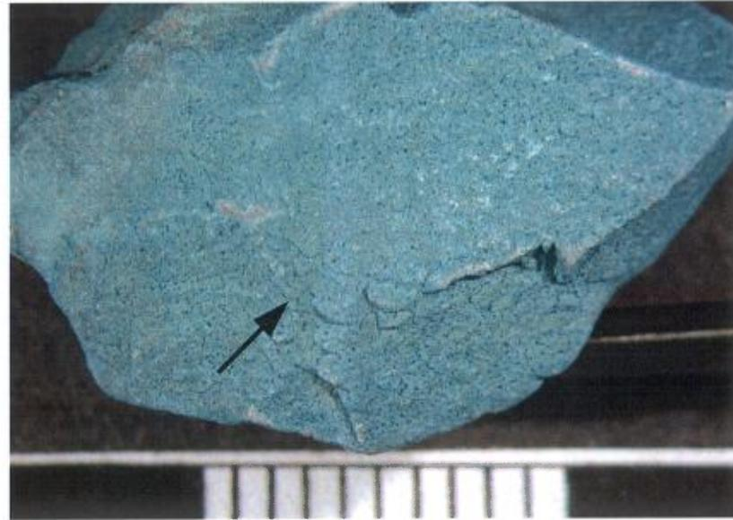
**PHOTO 42** – Granulat de dolomie à grain fin non argileux vu à la loupe 10x. La flèche indique une surface avec cassures pseudo conchoïdales. Observez la fine texture grenue représentée par les grains noirs. Coloration chimique. Échelle en cm.
