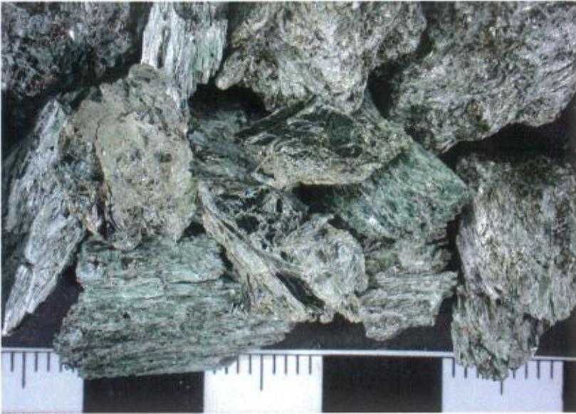
**PHOTO 49** – Granulats de schiste micacé. Observez les feuilletés de micas qui forment la schistosité. Échelle en cm.
