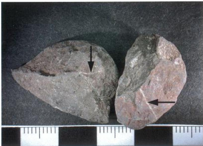
**PHOTO 29** – Granulats de calcaires argileux. Les fragments ont des formes cuboïdes. Observez les rayures au couteau (flèches) et l'aspect terreux à la surface des échantillons. L'échantillon de gauche correspond à la photo 30. Coloration chimique. Échelle en cm.
