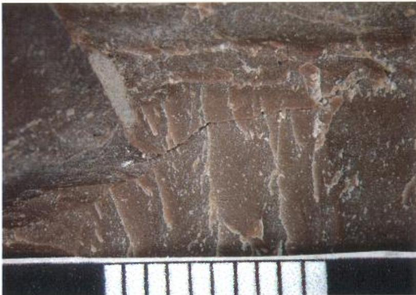
**PHOTO 43** – Granulat de calcaire à grain fin non argileux vu à la loupe 10x. Les cassures conchoïdales observées sur toute la surface signalent une granulométrie de la taille des argiles. Coloration chimique. Échelle en cm.
