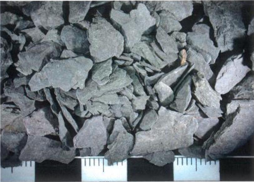
**PHOTO 9** – Granulats de shales. Les fragments ont des formes de plaques allongées. Échelle en cm.
