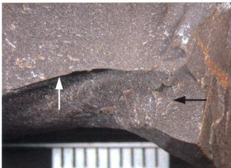
**PHOTO 55** – Granulat de cornéenne vu à la loupe 10x. Observez les cassures conchoïdales (flèche noire) et les bords tranchants (flèche blanche). Échelle en cm.
