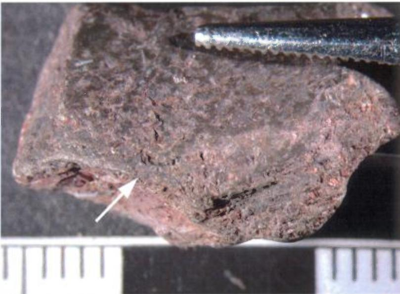
**PHOTO 35** – Calcaire avec placage argileux vu à la loupe 10x. Le placage argileux a tendance à se séparer en feuillets (flèche). Coloration chimique. Échelle en cm.
