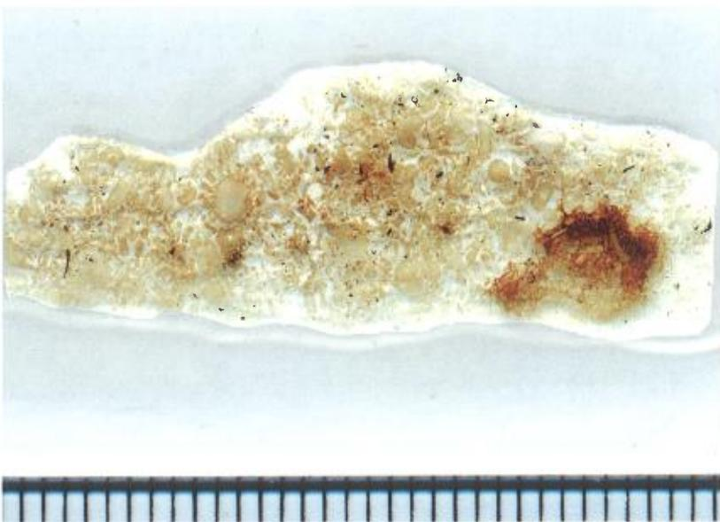
**PHOTO 47** – Lame mince du granulat de calcaire cristallin des photos 45 et 46. Les fossiles sont les éléments figurés foncés. La sparite est interstitielle et incolore. Échelle en mm.
