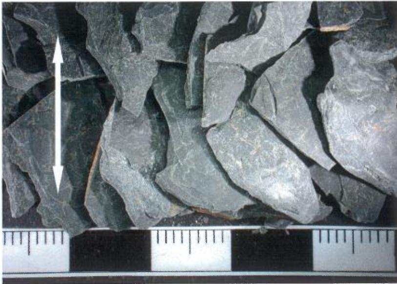
**PHOTO 13** – Granulats de shales. Les fragments ont des formes de plaques allongées. Observez sur chaque fragment les plans de fissilité parallèles au plan de la photo (double flèche). La couleur rouge indique l'oxydation de sulfure de fer. Échelle en cm.
