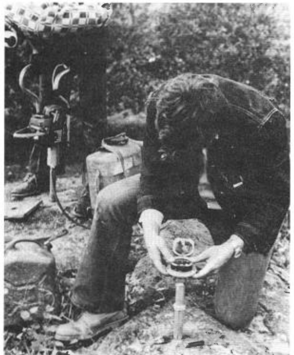
FIGURE 3 - Equipement employé pour l'orientation des échantillons cylindriques.
