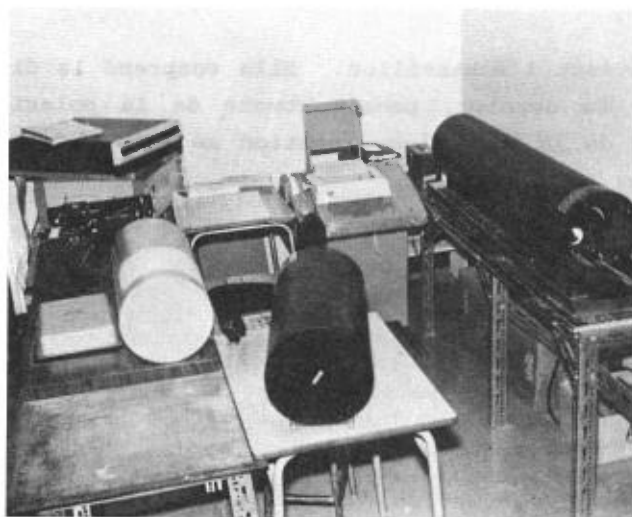
FIGURE 5 - Magnétomètre rotatif digitalisé et ses accessoires tels que mini-ordinateurs, télétype, etc.
