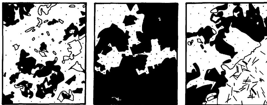
FIGURE 77 - Dessins à la chambre claire de roches ferrifères magnétiques. Magnétite en noir; hématite en blanc; gangue de silicate en pointillé; aiguilles de minnesotaïte (dessin de droite) représentées par des lignes noires.
