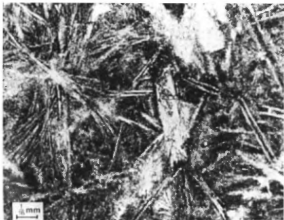
FIGURE 61 - Plagioclase de trempe à coeurs creux et queues fourchues; rosettes de clinopyroxène de trempe et de plagioclase de trempe. Feuille du Lac Nachicapau. Lumière polarisée non analysée.
