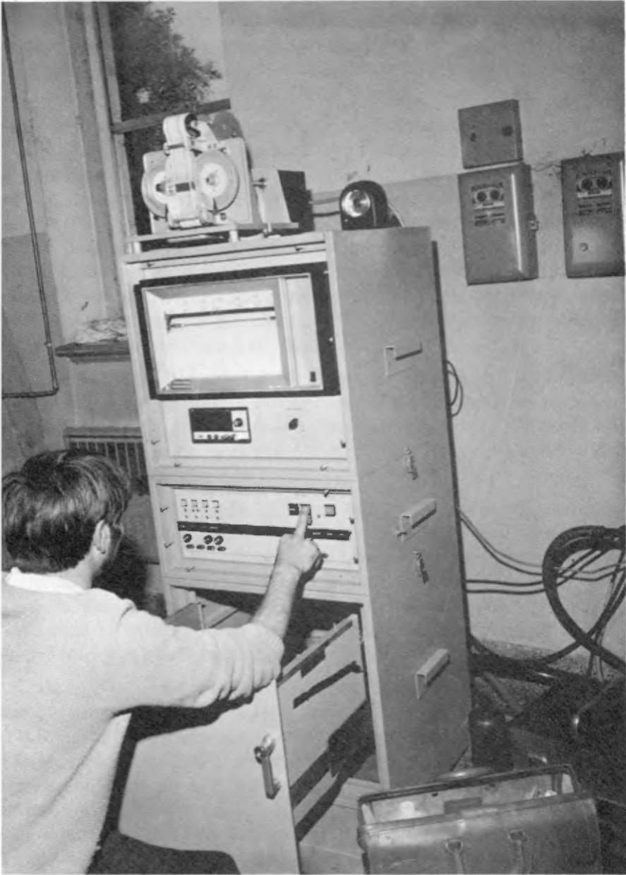
**Moniteur pour l'enregistrement continu de paramètres physico-chimiques et enregistrement sur bande continue et sur ruban perforé.**
