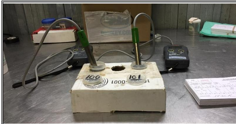
**Figure 5: Instrumentation de détermination du pH**
