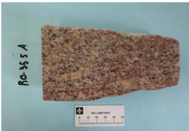
PHOTO 5 - Granite porphyrique du Pluton de Mistaouac, à phénocristaux de feldspath alcalin (Amst3). Notez la présence de fractures avec une forte hématitisation de la roche en périphérie. Sondage RO-355 (654558E, 5440721N).
