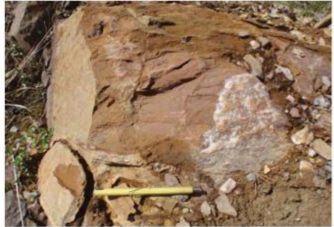
PHOTO 2 - Coulée massive de basalte fortement ankéritisée. Formation de Clermont-Disson (Acd1). Affleurement 12-PL-1050 (655964E, 5432244N).
