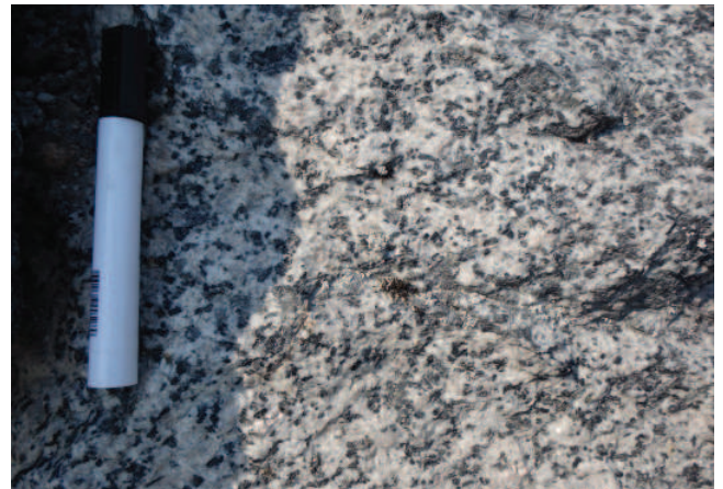
PHOTO 6 - Monzonite à hornblende avec un peu de biotite de l’unité nApol4 (Batholite de Polaris). La roche est massive avec un aspect moucheté. Le crayon mesure 14 cm (affleurement 2013-HH-2054; 33H15, UTM NAD83 zone 18 661210E 5974157N).
