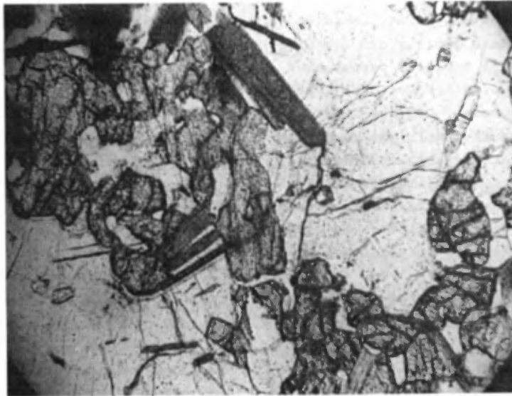
FIGURE 8 - Gneiss à plagioclase, hypersthène, biotite et grenat (20x). / Plagioclase - hypersthene - biotite - garnet gneiss (20x).
