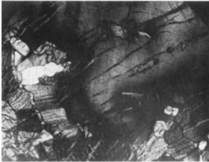
FIGURE 5 - Extinction zonée du plagioclase dans le métagabbro (60x). Zoned extinction of plagioclase in metabasite (60x).
