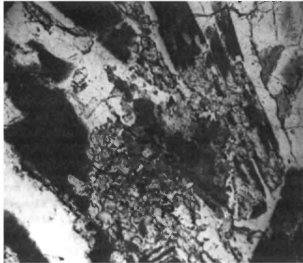
FIGURE 27 - Métadiabase. Les bâtonnets de plagioclase contiennent une forte quantité de magnétite (20x). / Metadiabase. The plagioclase laths contain abundant magnetite (20x).
