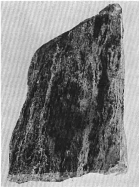
c) Magnétite, pyrite et pyrrhotine foliées. Les foliations de chlorite (noire) sont intercalées avec les sulfures. A comparer avec le secteur "B", pl. IVa. (Mattagami Lake Mines, x1).
