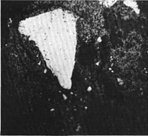
a) Fragment de pyrite dans la sphalérite et la gangue. Mattagami Lake (x 14).
