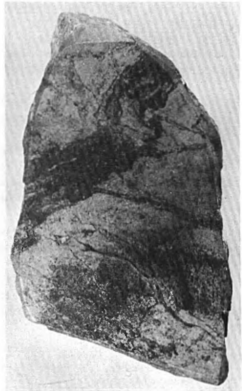
d) Pyrite bréchée avec veinules de magnétite (noire). (Mattagami Lake Mines, x1).
