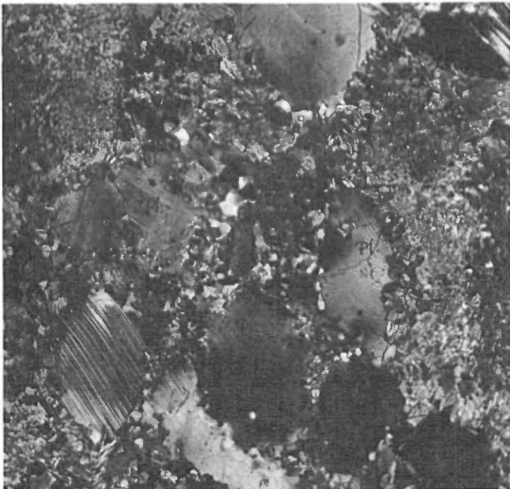
B- L-9-2. Microphotographie (nicols croisés) d'une roche passant du gabbro granulitique à l'amphibolite. Notez la granulation marginale du plagioclase (Pl.)
