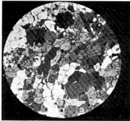
B - Texture granoblastique dans le facies dioritique. Noter les cristaux idiomorphiques de hornblende. (x 80) Lumière naturelle.
