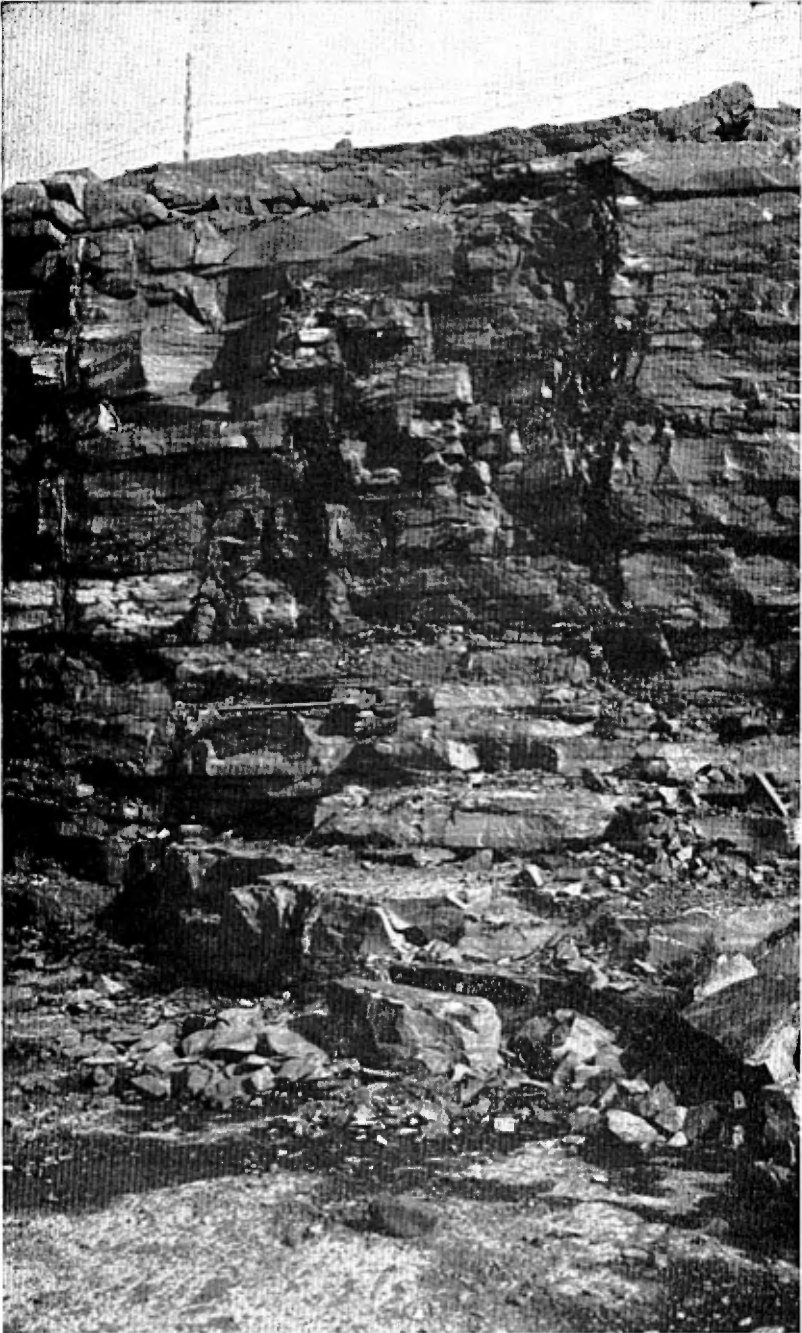
Dolomie de Beekmantown. Mur nord-est de la carrière Marchand & Frères, située à un demi-mille au sud-ouest de Châteauguay, feuille "Lachine" (p. 26). La roche est composée de lits de dolomie relativement pure et de quelques lits minces de calcaire.
