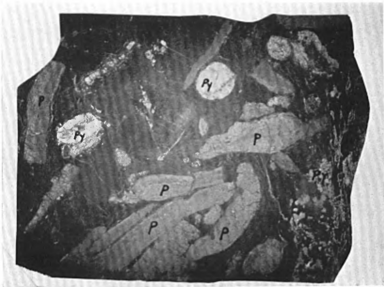
A.—Lave fragmentaire, à l'Ouest de la baie Dunlop. Il y eut substitution des fragments par de la pyrrhotine (P) et de la pyrite (Py) et des filonnets de pyrite recourent la pyrrhotine.
