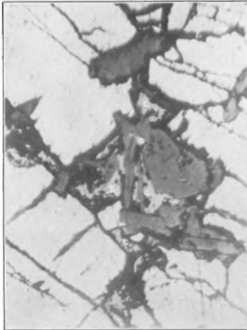
Surface polie d'un spécimen de minerai au sud de la marge nord du gisement No. 6. Grossissement 66 diamètres. (C) chalcopyrite; (S) sphalérite; (blanc) pyrite; (gris foncé) chlorite.
