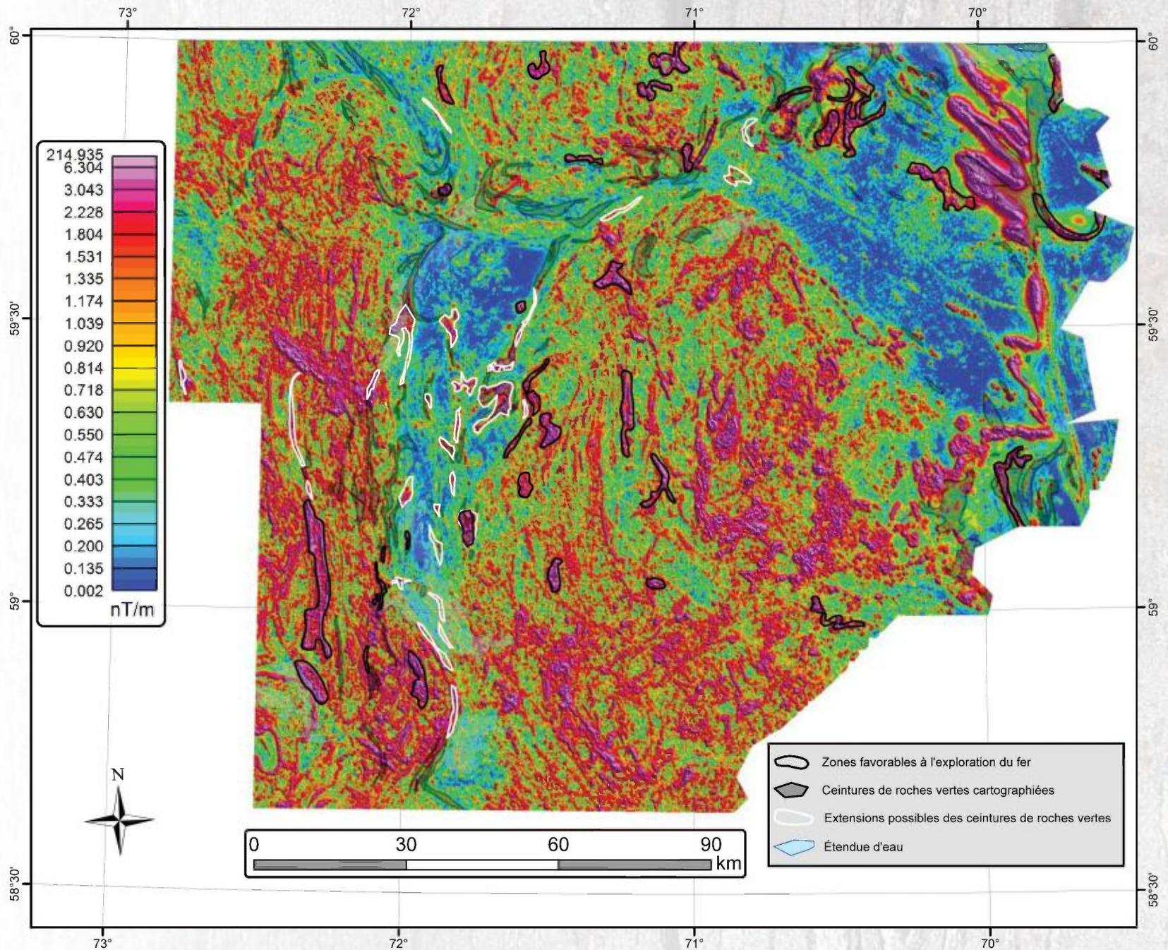
FIGURE 7 – Zones favorables pour l'exploration des formations de fer et des extensions possibles de ceintures de roches vertes évaluées qualitativement à partir des signatures des anomalies aéromagnétiques, superposées sur la carte du signal analytique de la composante résiduelle du champ magnétique total.
