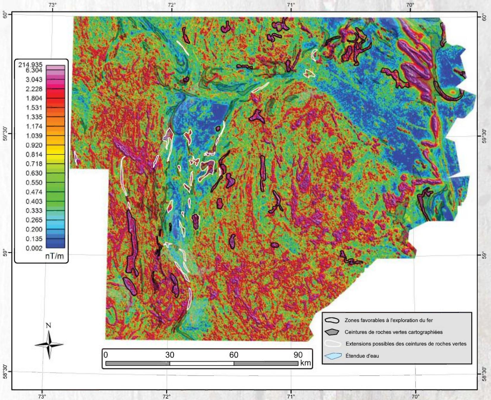
FIGURE 8 – Zones favorables pour l'exploration des formations de fer et des extensions possibles de ceintures de roches vertes évaluées qualitativement à partir des signatures des anomalies aéromagnétiques, superposées sur la carte de la première dérivée verticale du champ magnétique total.
