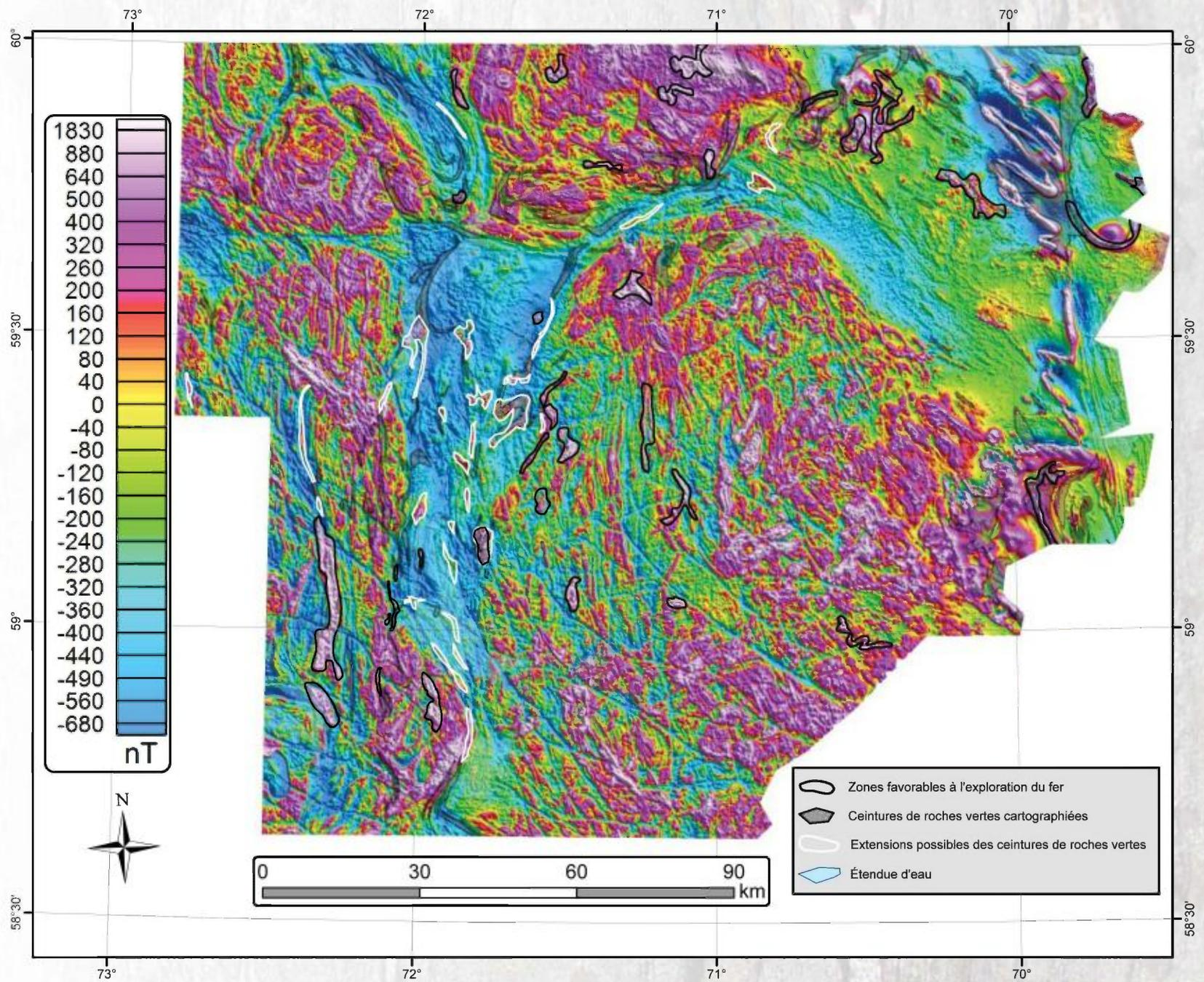
**FIGURE 6** – Zones favorables pour l’exploration des formations de fer et des extensions possibles de ceintures de roches vertes évaluées qualitativement à partir des signatures des anomalies aéromagnétiques, superposées sur la carte de la composante résiduelle du champ magnétique total.
