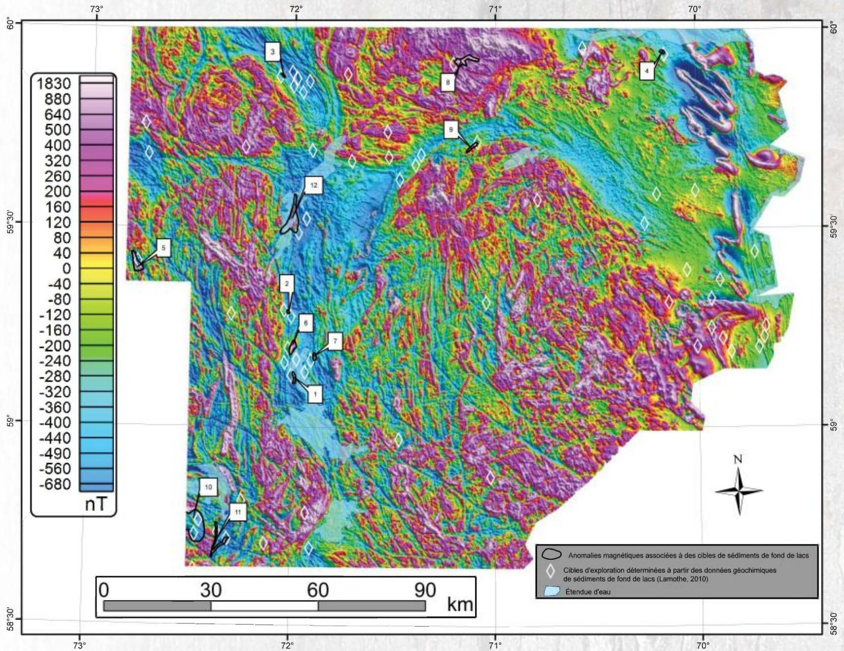
**FIGURE 3** – Cibles d’exploration définies à partir des anomalies aéromagnétiques associées à des cibles de géochimie de fond des lacs, superposées sur la carte de la composante résiduelle du champ magnétique total.
