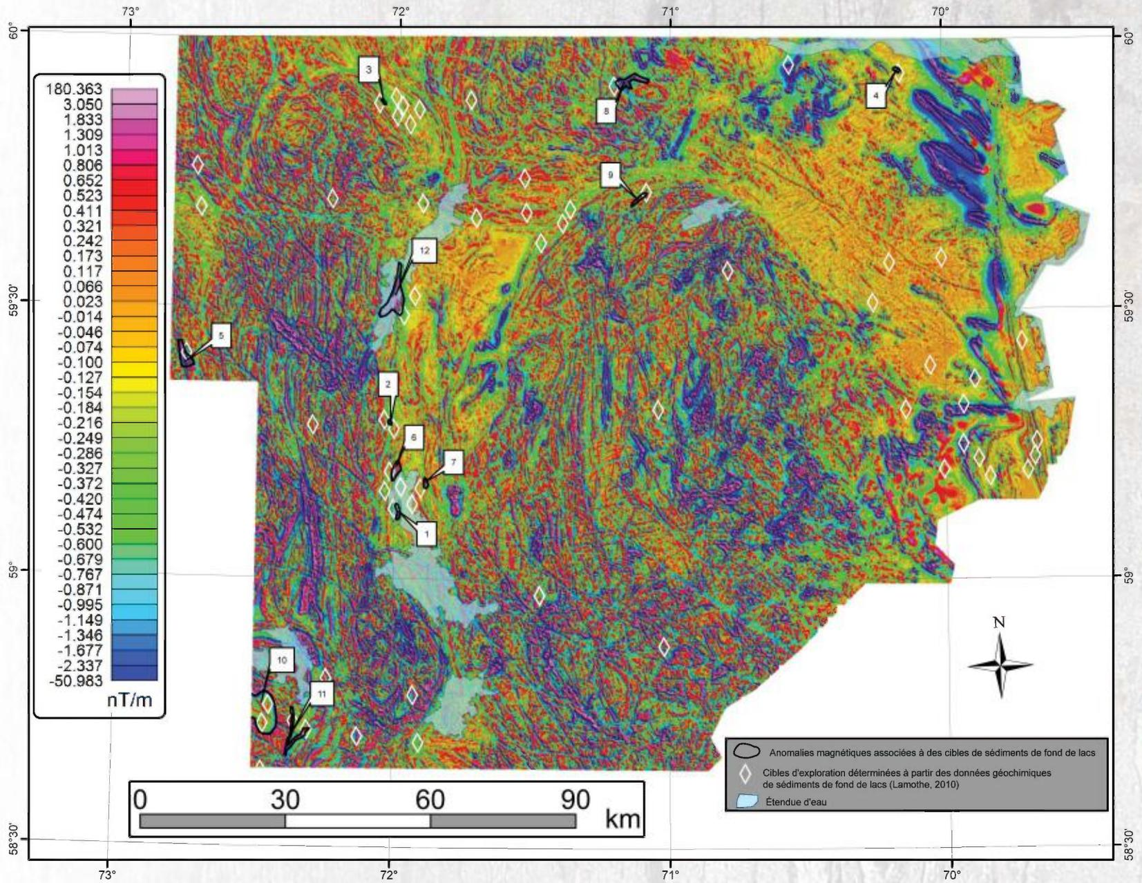
**FIGURE 5** – Cibles d'exploration définies à partir des anomalies aéromagnétiques associées à des cibles de géochimie de fond des lacs, superposées sur la carte de la première dérivée verticale de la composante résiduelle du champ magnétique total.
