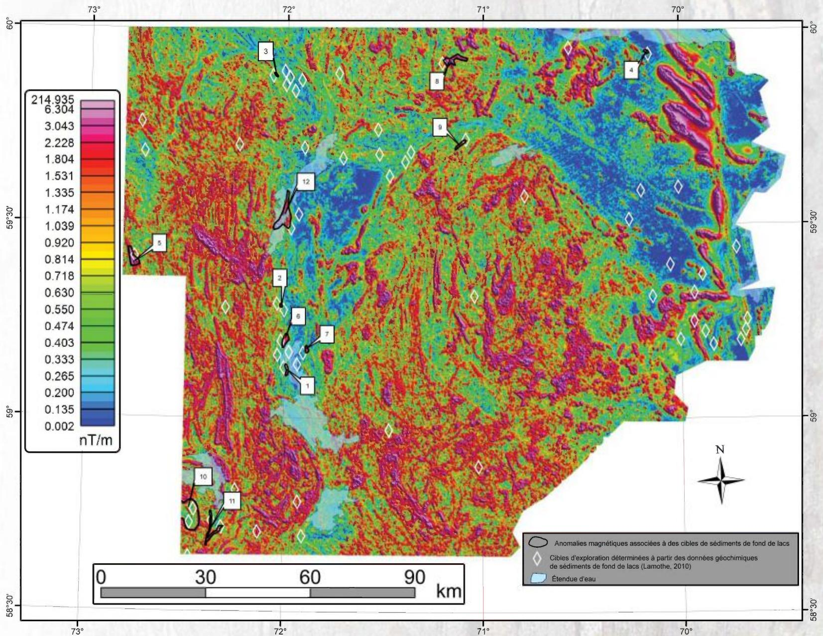
**FIGURE 4** – Cibles d'exploration définies à partir des anomalies aéromagnétiques associées à des cibles de géochimie de fond des lacs, superposées sur la carte du signal analytique de la composante résiduelle du champ magnétique total.
