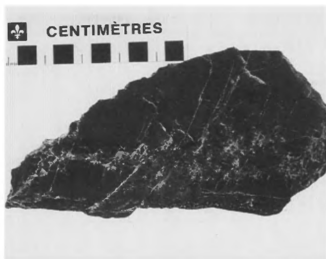
FIGURE 39 – Mine O'Brien. Échantillon spectaculaire d'or (pâle) remplissant des fractures tardives dans le quartz gris foncé. Les traînées de points blancs visibles à la partie inférieure de l'échantillon sont de l'arsénopyrite.
