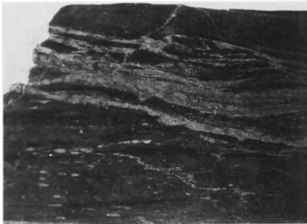
FIGURE 24 – Mine Bousquet. Veine du système majeur montrant une relation angulaire horaire par rapport à S_1 . Notez le cisaillement au contact veine-éponte.
