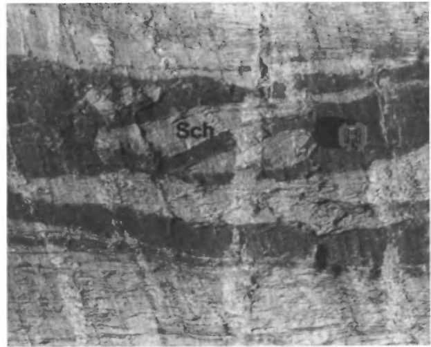
FIGURE 29 – Mine LaRonde. Inclusions de schiste à andalousite (Sch) dans les corps de pyrite massive de la zone sud.
