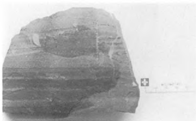
FIGURE 36 — Roche cornéenne. Shale et grès du Pontgravé transformés en une cornéenne dense, de couleur gris brun avec une altération brun rosé. Petite Caroline, mont Rougemont.
