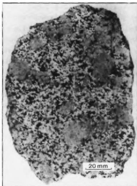
FIGURE 44 - Granitoïde porphyroblastique. Phénoblastes de microcline dans une trame de monzodiorite quartzifère. Bande B de la figure 45.
