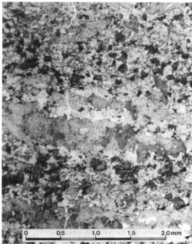
FIGURE 9 - Tuf bicolore. Alternance de niveaux riches en amphibole et de niveaux composés de plagioclase, de quartz, d'amphibole et de biotite. Lumière naturelle.
