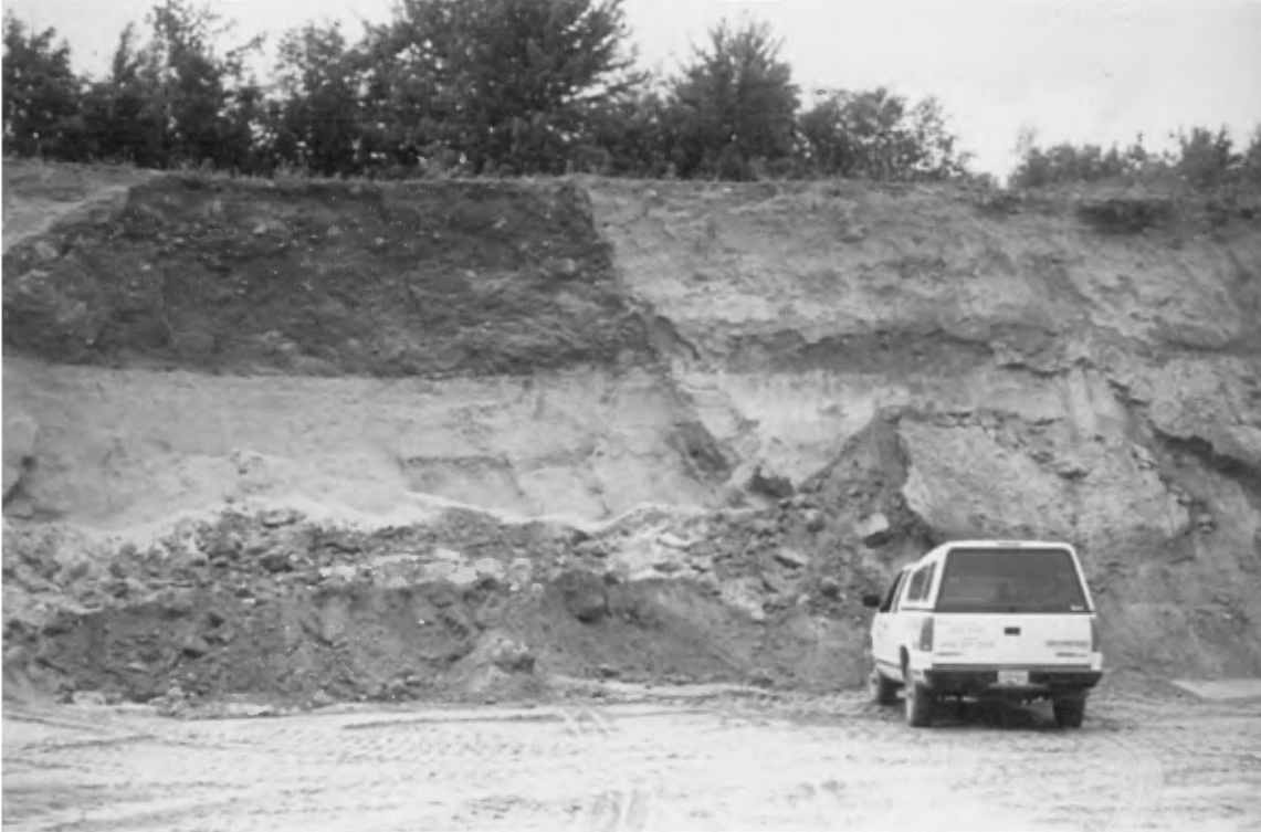
photo 5: Coupe à l'intérieur d'une crête à Saint-Césaire: 3 m de till (Saint-Jacques) reposent sur 4 à 5 m de sable fin à silteux de la Formation de Châteauguay (banc 19, gisement 5).
