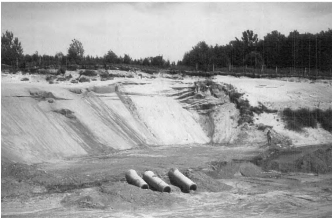
photo 12: Coupe de 8 m de hauteur constituée de sable moyen à fin stratifié et légèrement graveleux à la base (banc 29, gisement 9).
