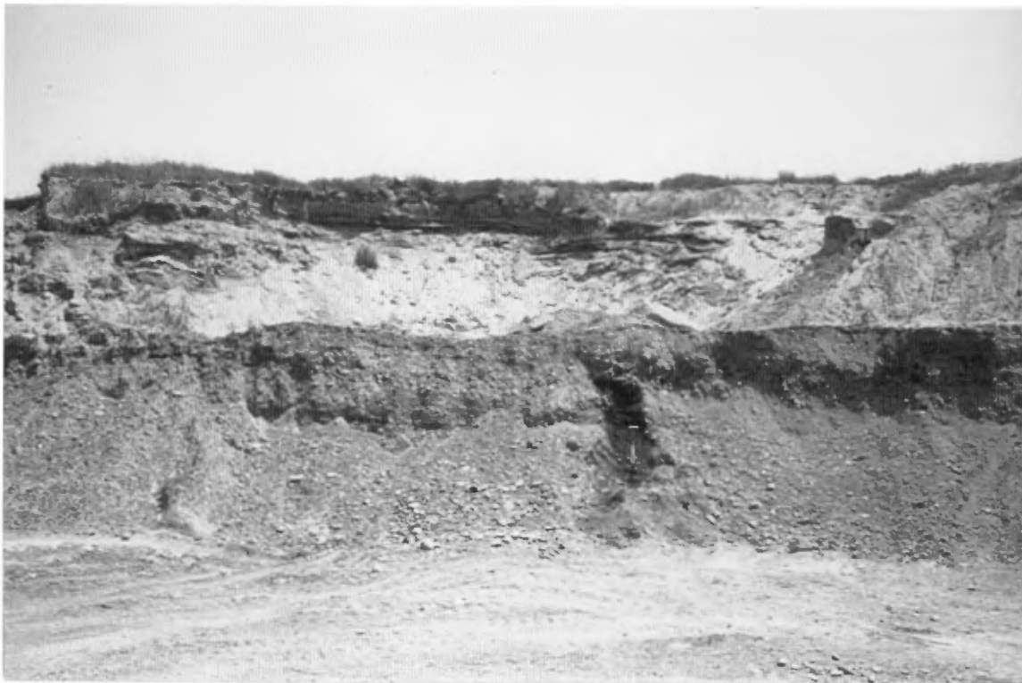
photo 2: Face formée de 3 à 4 m de sable fin à silteux stratifié reposant sur 3 m de sable graveleux (banc 1, gisement 1).
