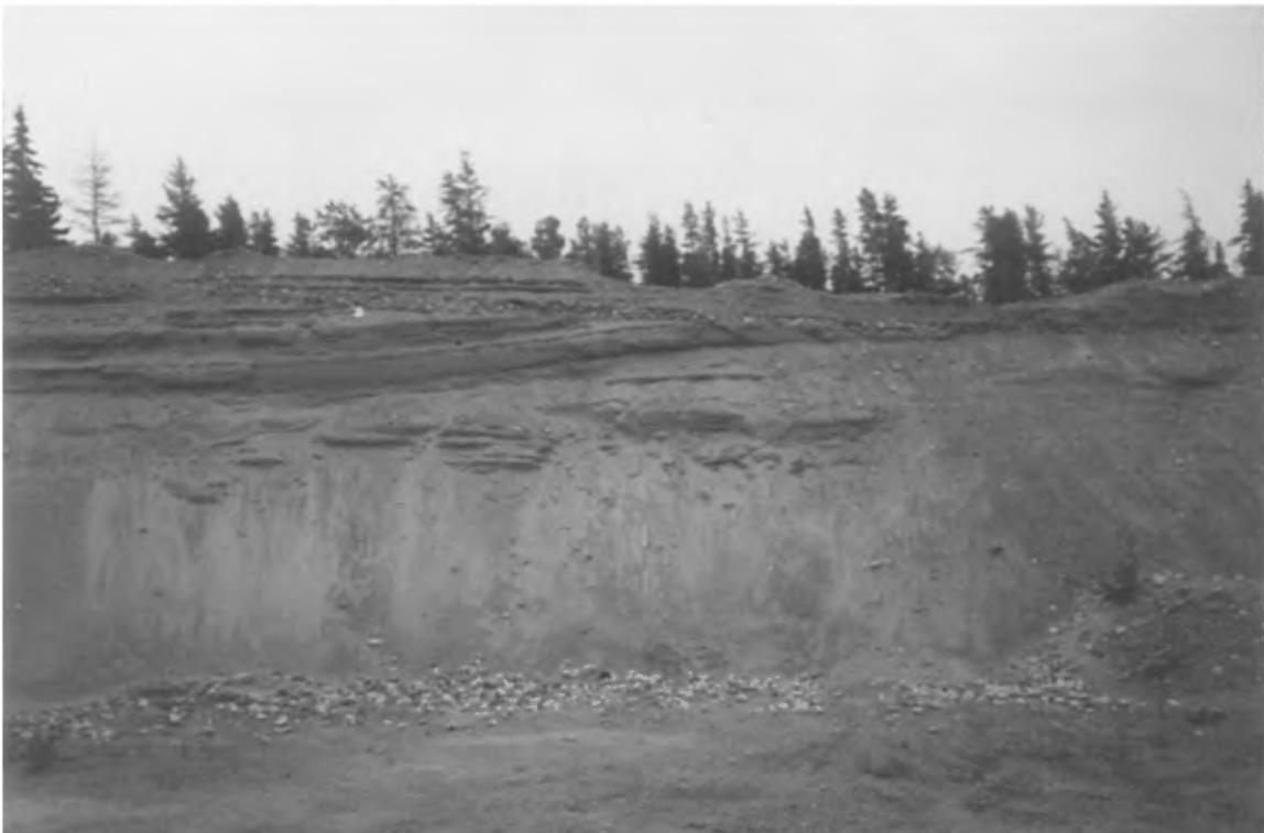
Photo 12 : Dépôt de sable graveleux et de silt. La face ouverte varie de 4 à 6 m de hauteur (gisement 10, banc 27, carte 32 C/12).
