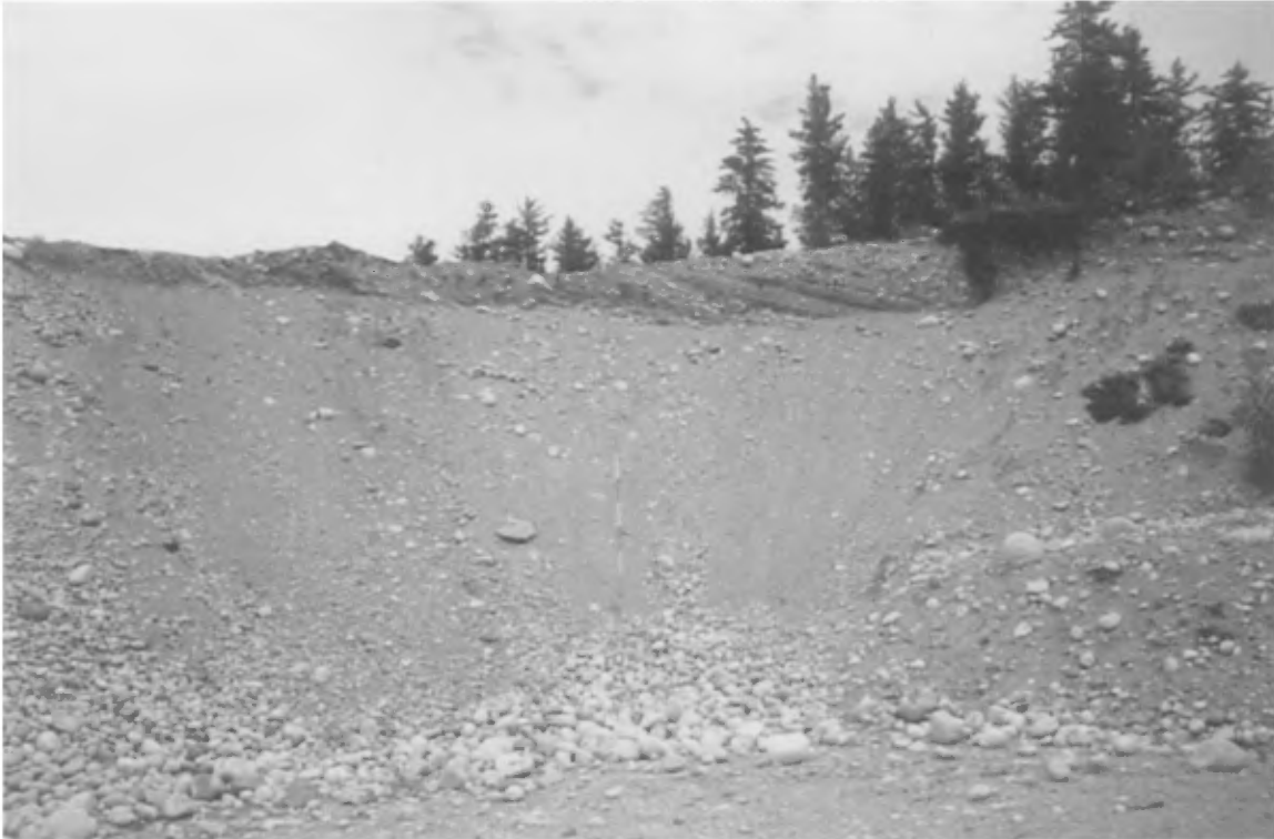
Photo 11 : Face de 6 m de hauteur ouverte sur la crête de la moraine d'Harricana. Le matériel est graveleux et contient quelques cailloux (gisement 12, banc 32, carte 32 C/12).
