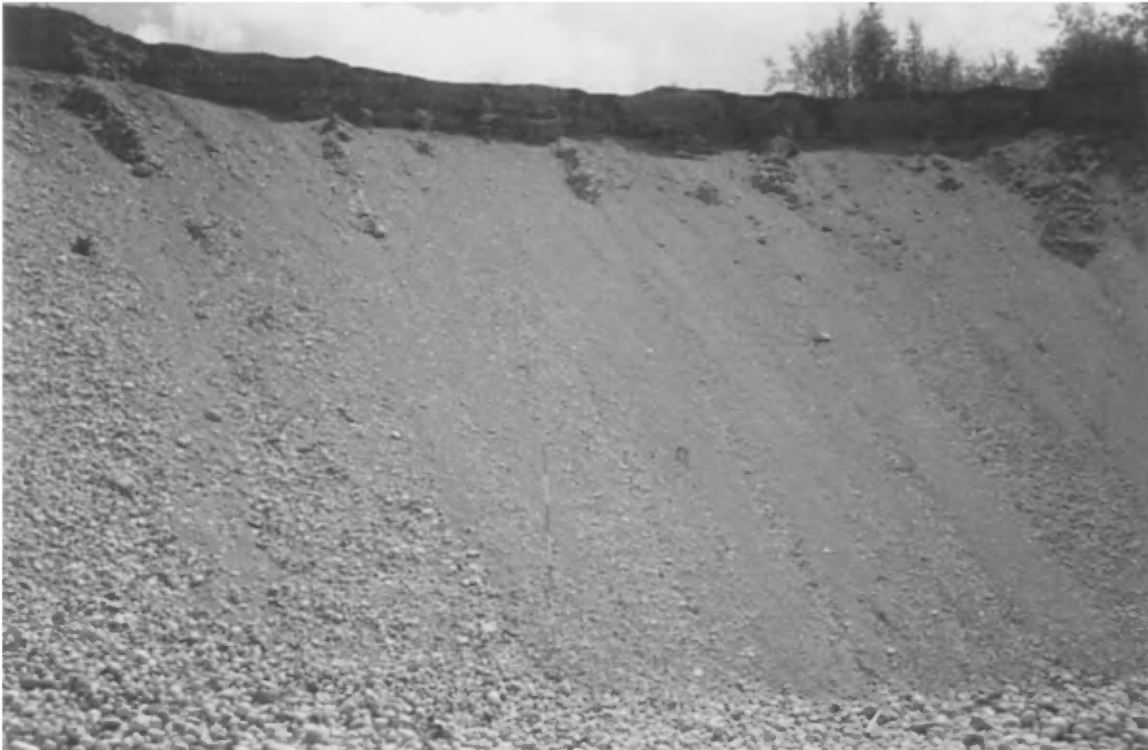
Photo 9 : Banc de gravier ouvert sur 14,9 m au sommet de la moraine interlobaire d'Harricana (gisement 11, banc 30, carte 32 C/12).
