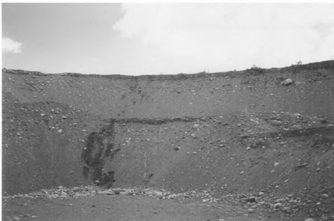
Photo 2 : Face de 11 à 12 m de hauteur composée de gravier légèrement caillouteux (gisement 4, banc 15, carte 32 D/9).
