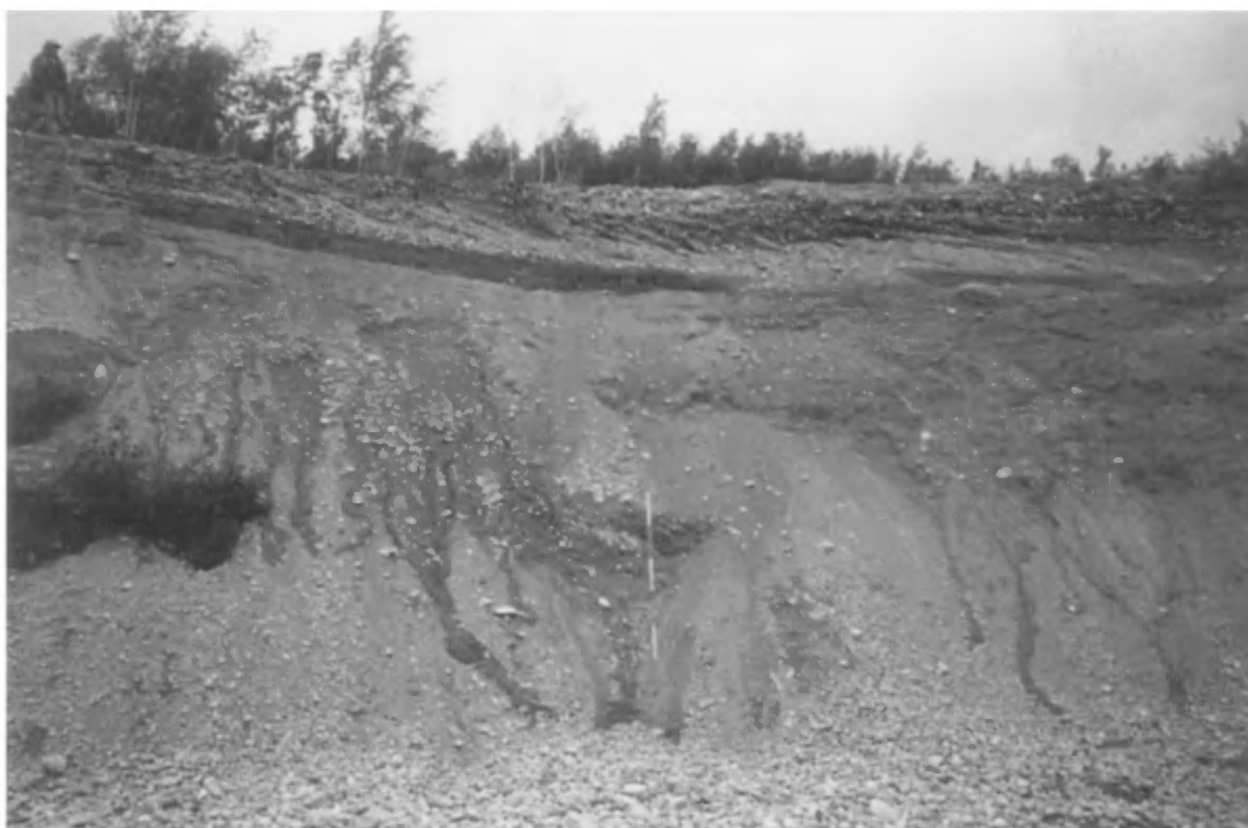
Photo 14 : Banc de 6 à 9 m de hauteur composé de sable graveleux (gisement 16, banc 40, carte 32 C/12).
