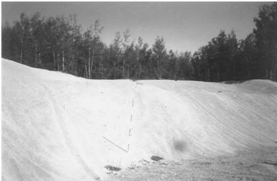
Photo 17 : Banc de sable moyen à grossier de 4 à 6 m de hauteur. Le banc a été exploité puis abandonné par la compagnie de chemin de fer Canadien national (gisement 18, banc 47, carte 32 C/12).
