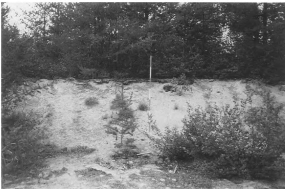
Photo 8 : Dépôt glaciolacustre composé de 2 à 5 m de sable et silt (gisement 6, banc 23, carte 32 D/9).
