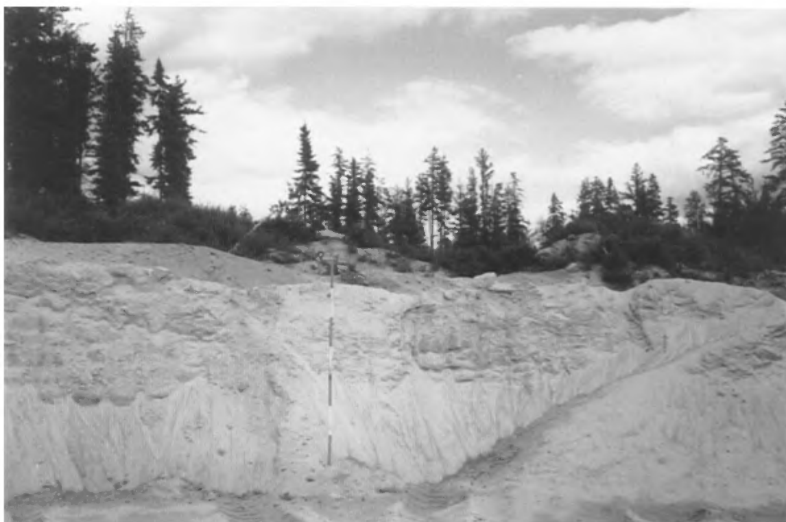
Photo 6 : Banc de sable interstratifié de lits silteux (gisement 3, banc 11, carte 32 D/9).
