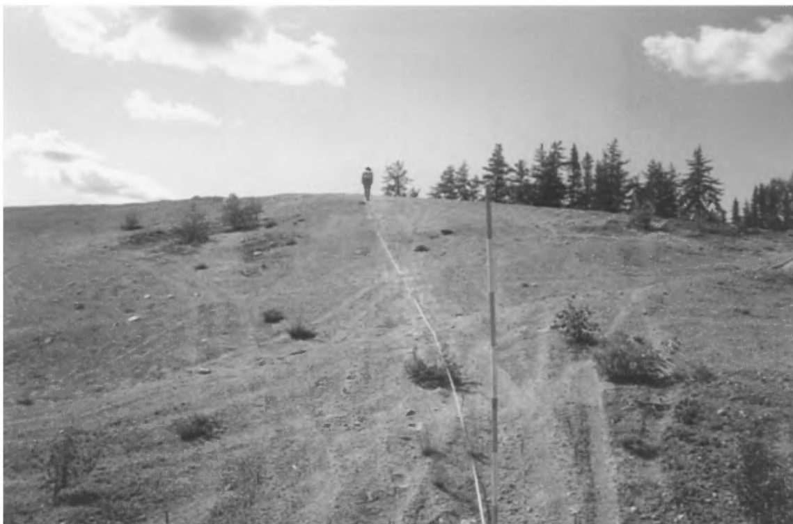
Photo 3 : Face abandonnée d'une hauteur de 16 m constituée de sable avec des interlits de gravier (gisement 5, banc 21, carte 32 D/9).
