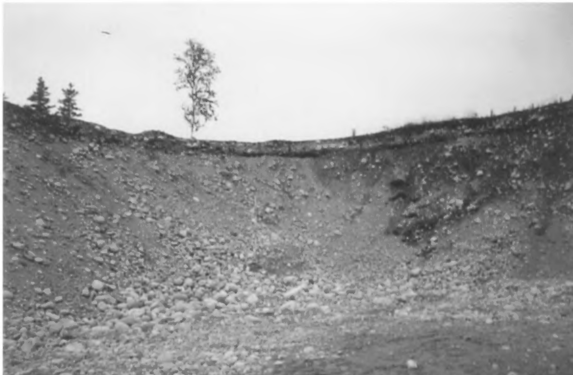
Photo 13 : Face de 6 à 8 m de hauteur composée d'un gravier pierreux (gisement 13, banc 36, carte 32 C/12).
