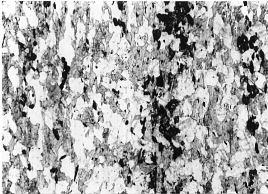
Figure n°3.33. Microphotographie, en lumière naturelle ( \times 2.5 ) de l'amphibolite encaissante n°G1. La texture est grano-lépidoblastique et les sulfures sont enlignés selon les plans de foliation.
