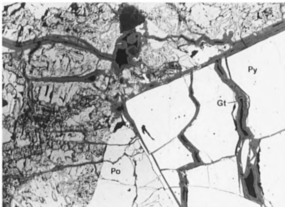
Figure n°3.24. Microphotographie, en lumière réfléchie ( \times 2.5 ) de l'échantillon E3 provenant de la zone à sulfures massifs. On observe une partie d'un mégacristal de pyrite (Py) recoupé et entouré par des veinules de goéthite (Gt), dans une matrice formée de pyrrhotite (Po) presque complètement transformé en marcassite (plus foncé).
