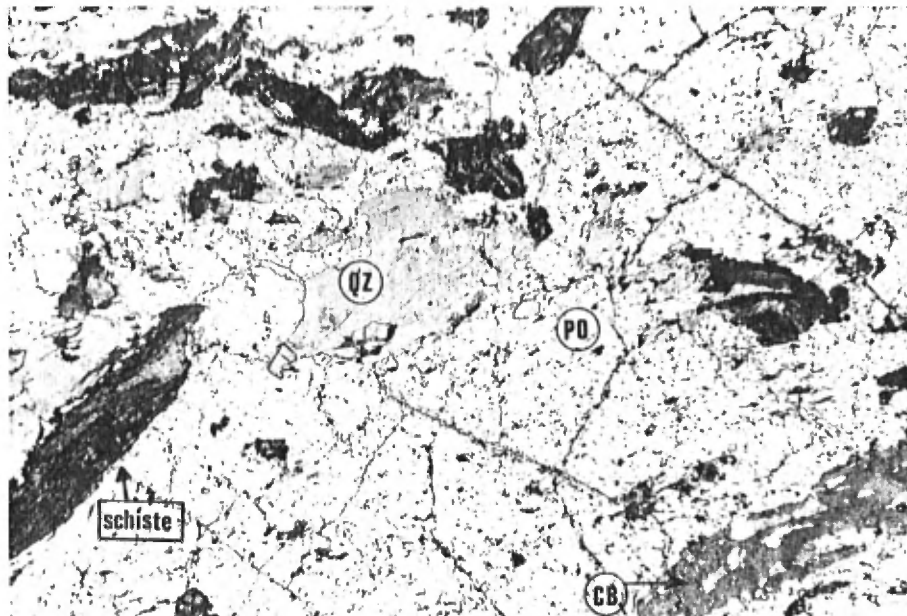
Planche 22. Photomicrographie (lumière réfléchie) de sulfures massifs de pyrrhotite et de chalcoppyrite, contenant 25% de fragments anguleux et contortionnés d'argilite, de siltite, de quartz, de carbonate et de schistes microlithiques (basalte), indice Charlie (2.5x, 9028-D1).
