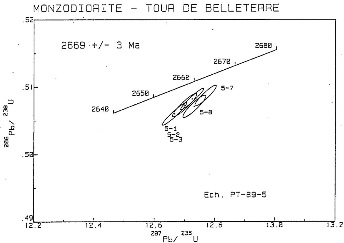
Figure 9. Diagramme Concordia illustrant les résultats obtenus sur des zircons de la monzodiorite du pluton de la Tour de Belleterre.
