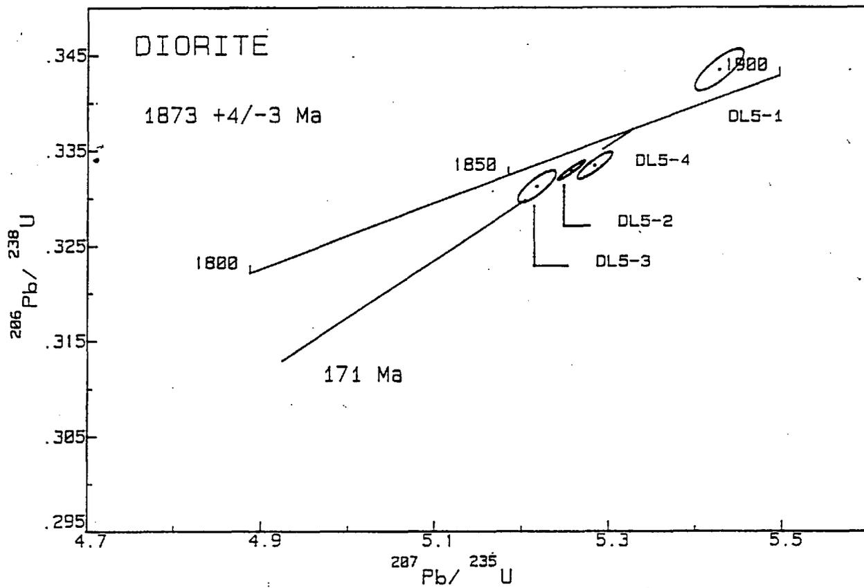
Figure 6. Diagramme Concordia illustrant les résultats obtenus sur des zircons tirés d'une diorite du Groupe de Parent.
