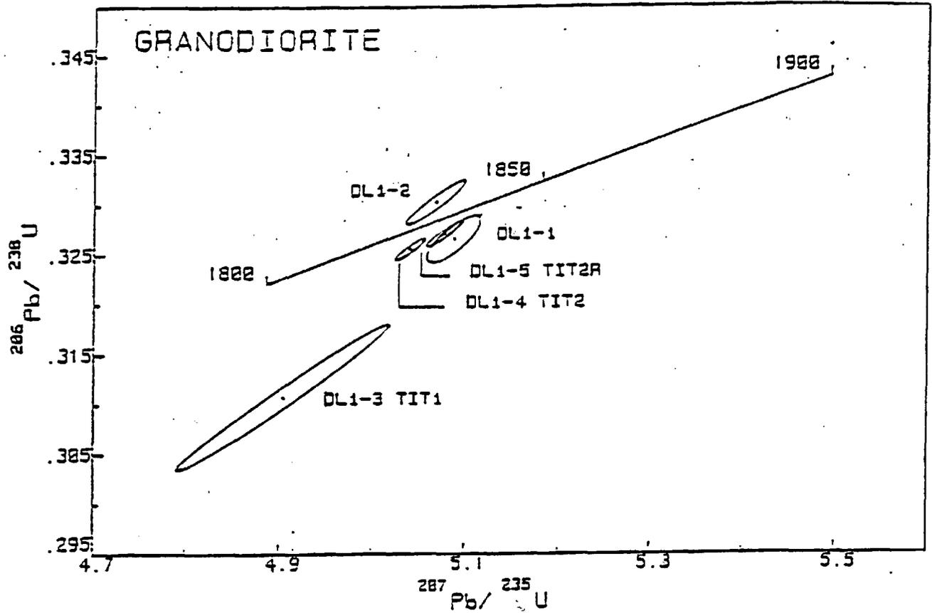
Figure 4. Diagramme Concordia illustrant les résultats obtenus pour deux fractions de zircons (DL1-1 et DL1-2) et trois fractions de titanite extraites d'une granodiorite foliée du Groupe de Parent.
