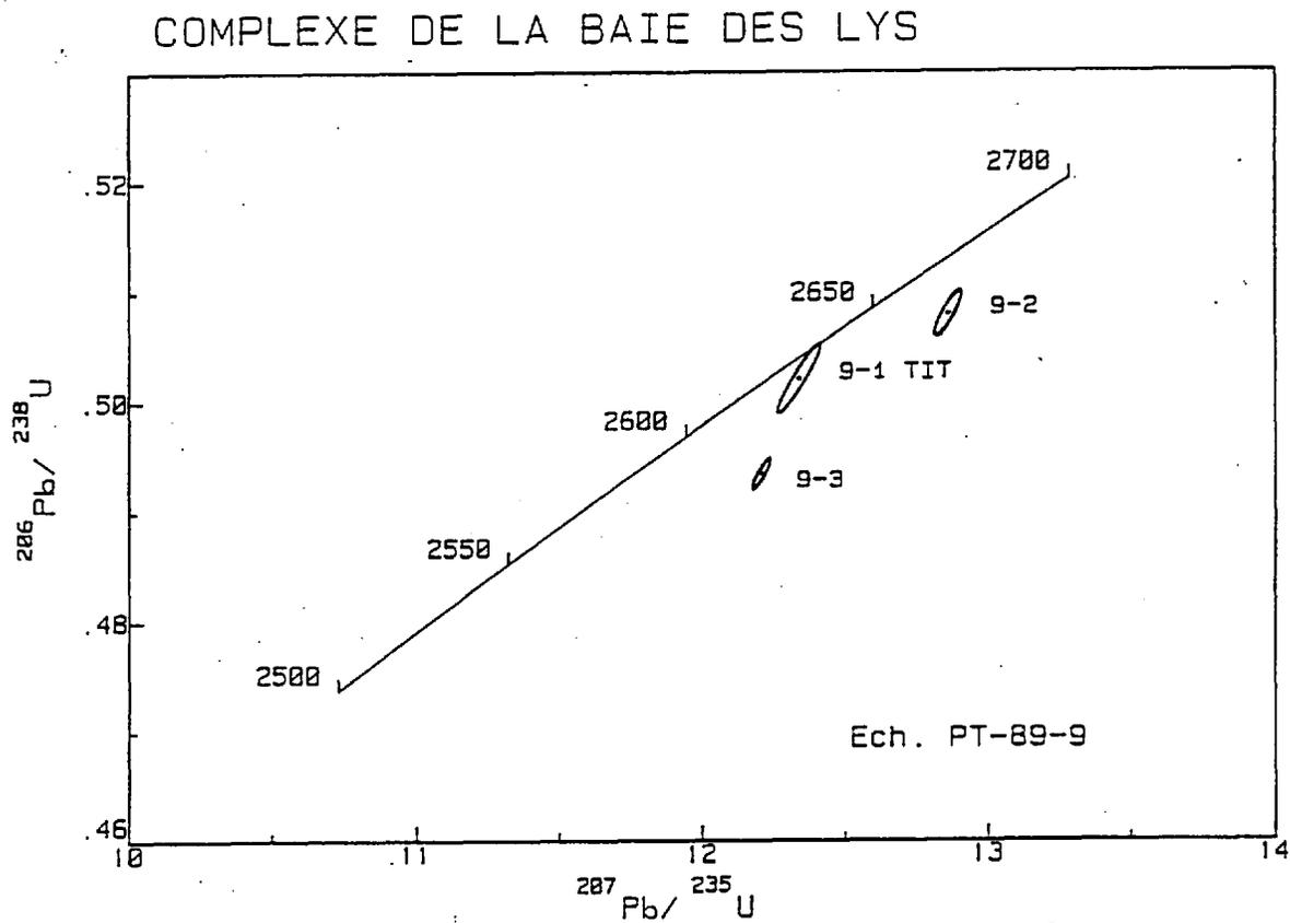
Figure 13. Diagramme Concordia illustrant les résultats obtenus sur des fractions de zircon (9-2 et 9-3) et de titanite (9-1 TIT) provenant d'un orthogneiss du complexe tonalitique de la Baie des Lys.
