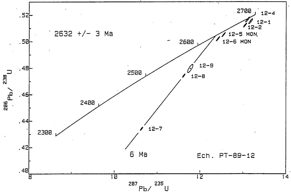
Figure 12. Diagramme Concordia illustrant les résultats obtenus sur des fractions de zircon (12-1, 12-2, 12-4, 12-7, 12-8 et 12-9) et de monazite (12-5 MON et 12-6 MON) provenant du monzogranite du Hallé dans le batholite de Décelles.
