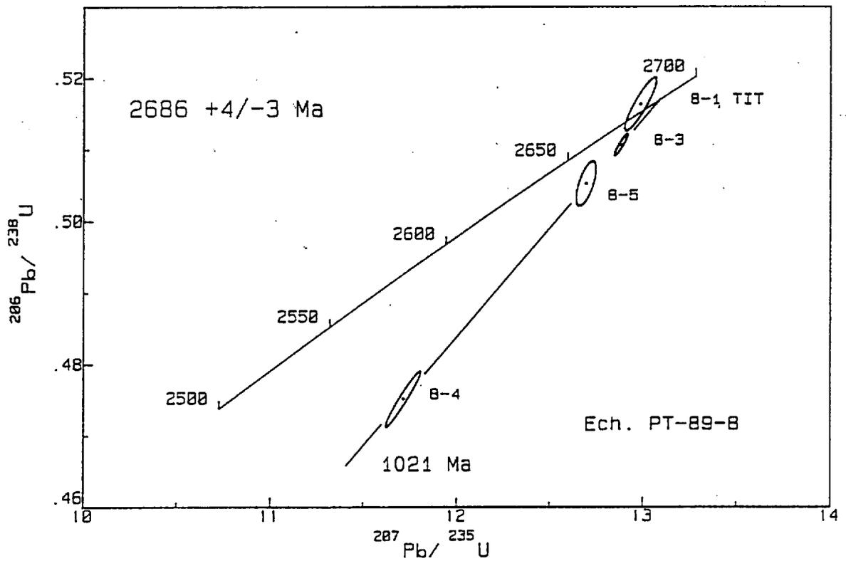
Figure 11. Diagramme Concordia illustrant les résultats obtenus sur des fractions de zircon (8-3, 8-4 et 8-5) et de titanite (8-1 TIT) provenant d'une monzonite à pyroxène du pluton du Lac Simard nord.
