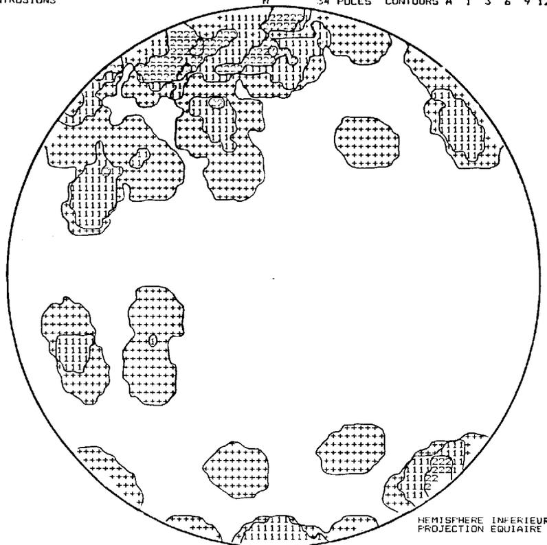
**Figure 50:** Diagramme de densité des pôles des cisaillements relevés à l'intérieur des intrusions.
