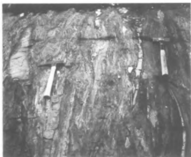
FIGURE 9 - Etirement et boudinage dans les roches sédimentaires.
