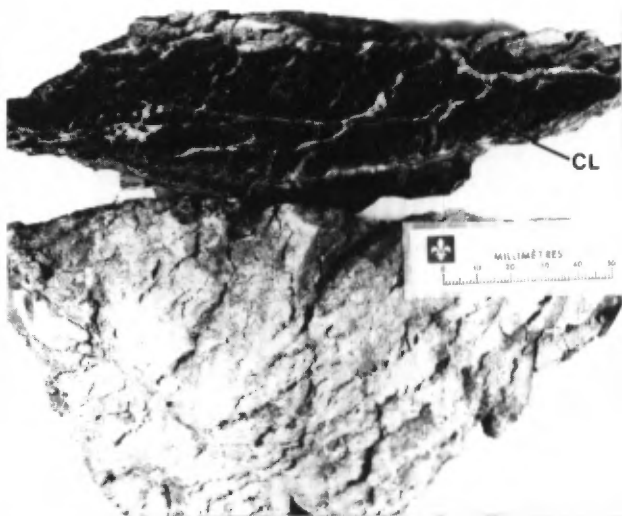
FIGURE 7 - Gabbro très fortement altéré (type 1). Le remplissage de fracture par la calcite (CL) est mis en évidence avec une vue en coupe (couleur blanche). Indice Franelle.
