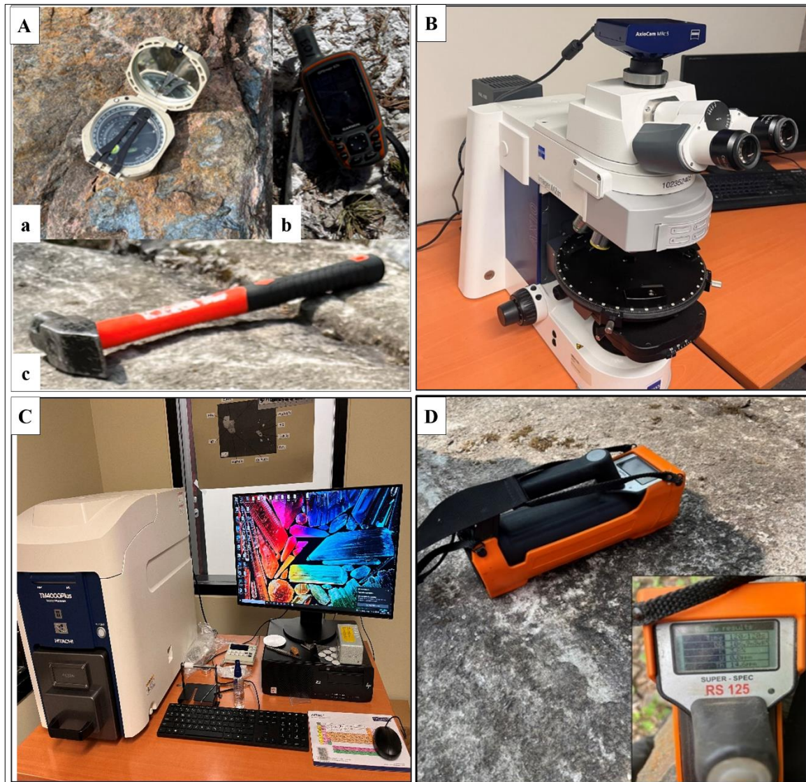
Figure 3 : Matériaux et équipements utilisés dans le cadre de cette étude. A : Matériaux de terrain : Boussole Brunton (a), GPS Garmin (b), Marteau (c); B : Microscope optique « Zeiss Axio Imager », équipé d'une caméra et d'un ordinateur à logiciel de calibration et de visualisation; C : MEB de table Hitachi TM4000 Plus de l'URSTM; D : Spectromètre portatif à rayons gamma RS-125 Super-SPEC.
